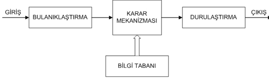
Şekil 2.1: Bulanık Mantık Denetleyici (BMD) temel yapısı
