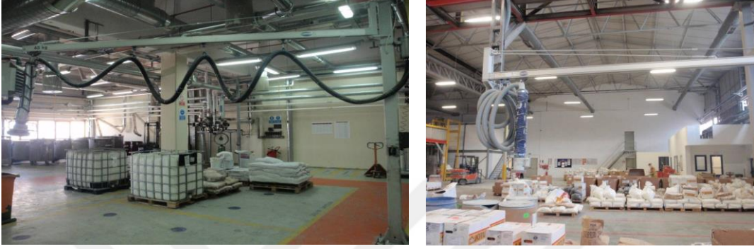
Resim 31 Exproof ve normal manipulatör sistemleri
