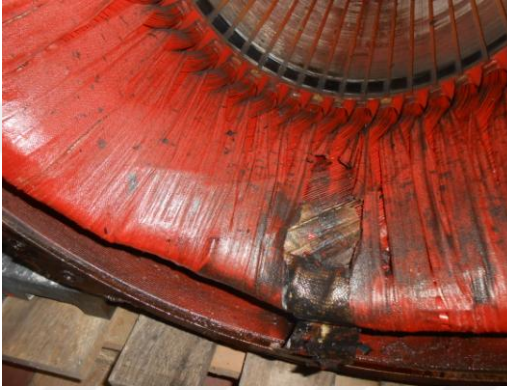
Resim 8 İzolasyon hatası olan motor
