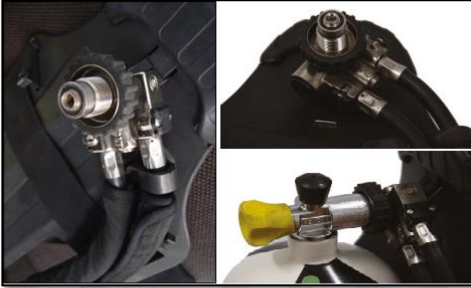
Şekil 30: Temiz hava solunum cihazı regülatör
