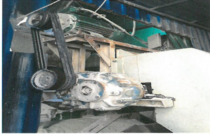
Resim2: Kayış-kasnak koruma muhafazası açık görüntüsü
