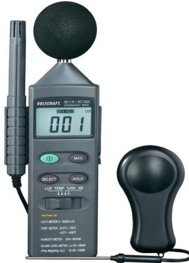
Şekil 13 : Sahada kullanılan CEM DT-8820 çok fonksiyonlu ölçüm cihazı
