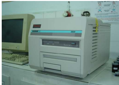
Şekil 3.1 Işınma ölçümlerinin yapıldığı TLD okuyucu sistemi (Harshaw TLD 3500).
