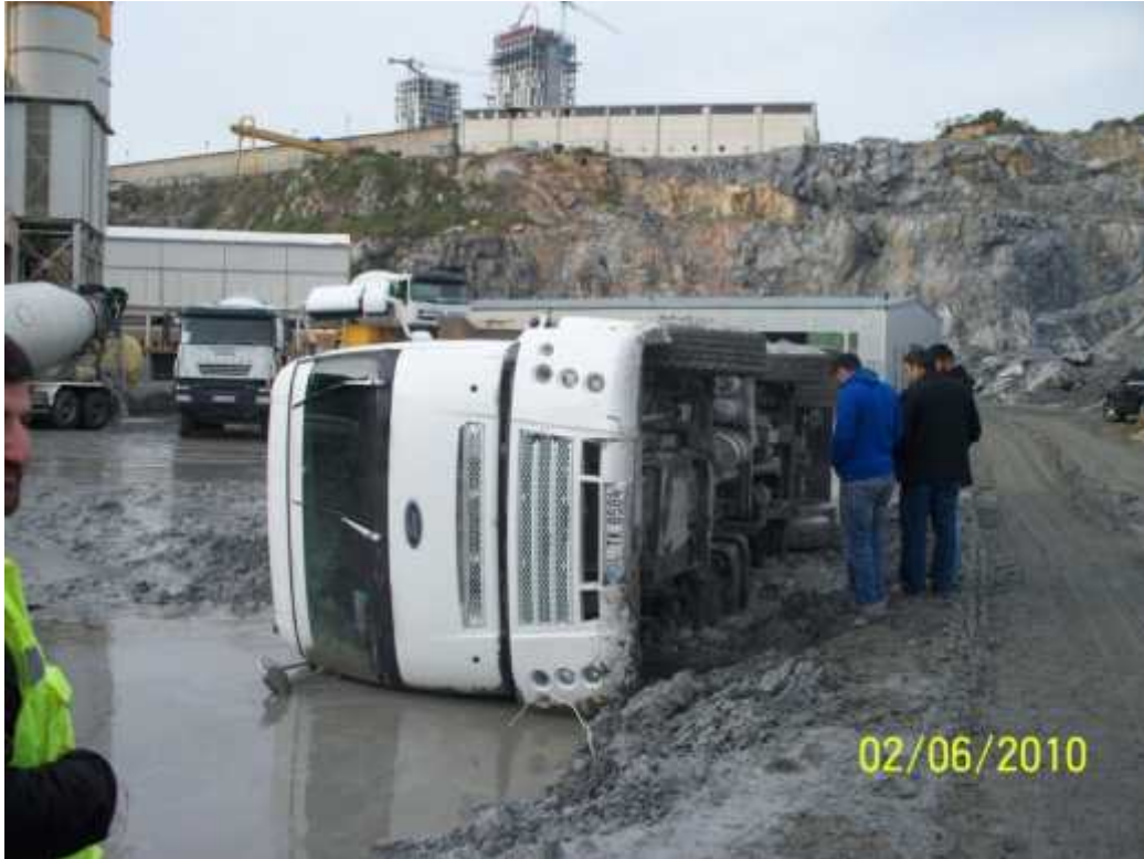
Resim 14- Hafriyat kamyonunun bozuk zeminden dolayı devrilmesi
