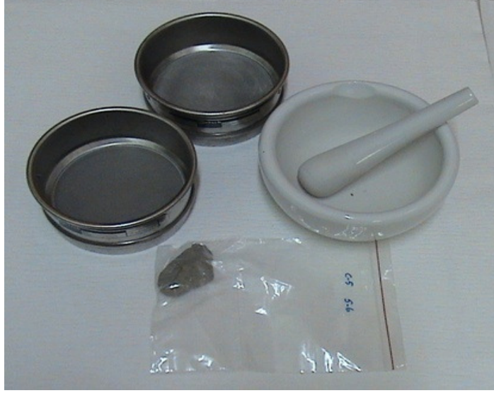
Şekil 3.4 çalışmada kullanılan analitik elek ve porselen havan
