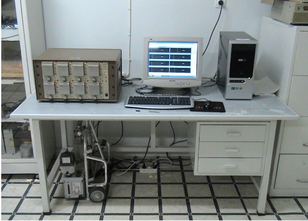
Şekil 3.7 Çalışmada kullanılan alfa spektroskopisi
