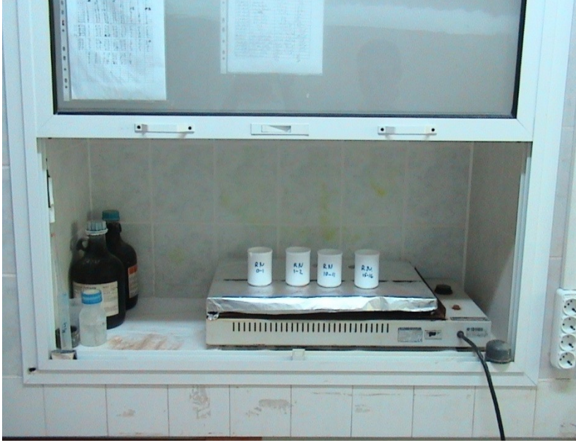
Şekil 3.5 Çalışmada kullanılan çeker ocak ve ısıtıcı tabla
