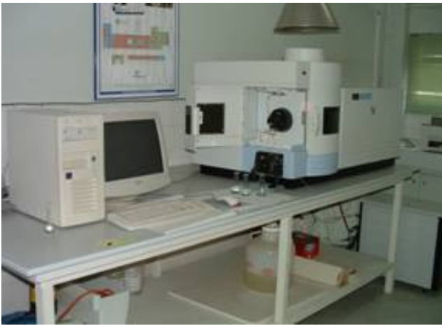
Şekil 3.9 PERKIN ELMER OPTIMA 2000DV model ICP-OES Sistemi
