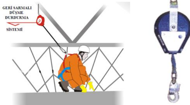
Şekil 14: Geri sarmalı düşme durdurucu sistem örnekleri
