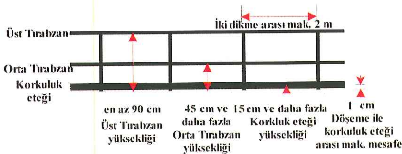
Resim 2.18. İSİGT Standartlarına Göre Korkuluk ve Korkuluk Eteği
