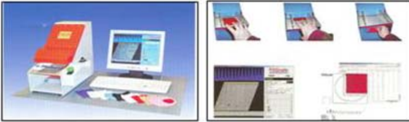
řekil 6.7: PillGrade boncuklanma deęerlendirme sistemi
