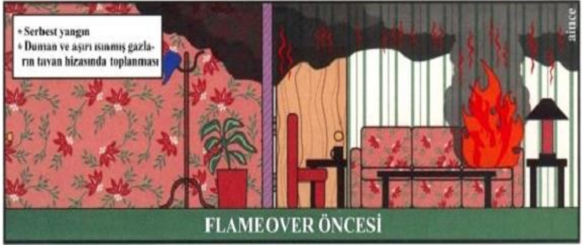
Şekil 2: Yarım yanmış gazların tavan hizasında toplanması
