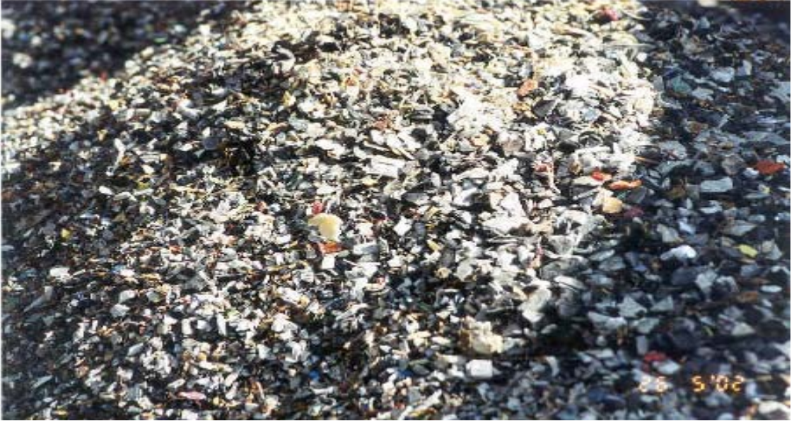
Şekil 11: Plastik parçalar ayırıcı tabla çıkışı
