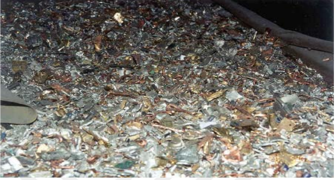
Şekil 10: Metal parçaları girdap akımı ayırıcısı 2 çıkışı
