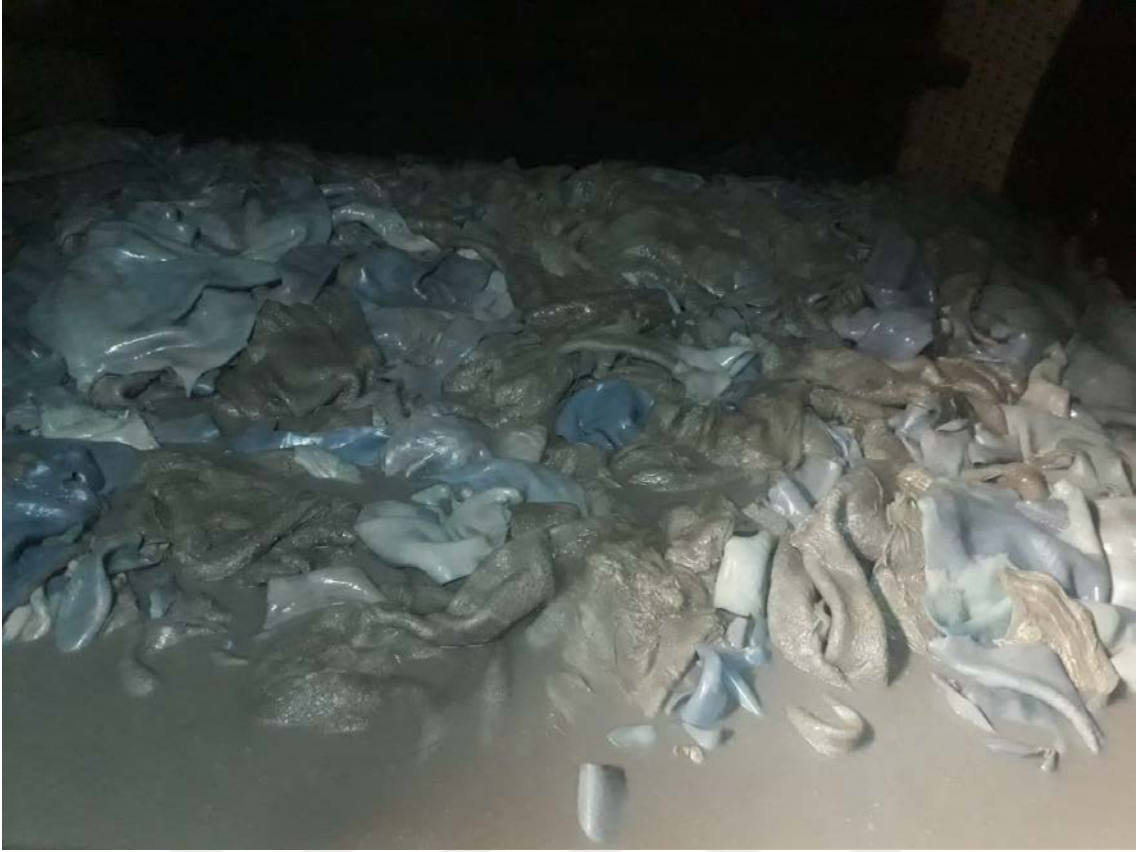
Resim 10: Retenaj işlemi dolap içi görünümü
