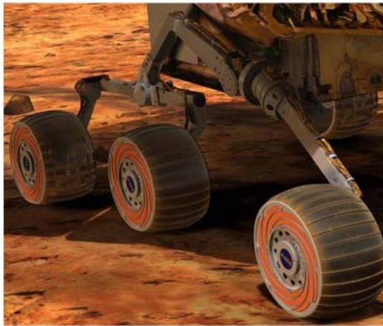
Şekil 2.4 NASA Spirit Rocker-bogie mekanizması (MER-NASA (2), 2009).
