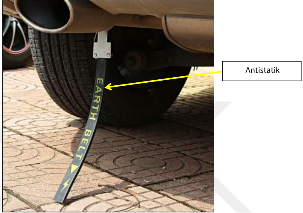
Resim 2:Araç topraklama lastiği (şok lastiği)
