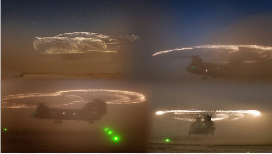
Resim 4:Helikopterde meydana gelen statik elektriklenme.
