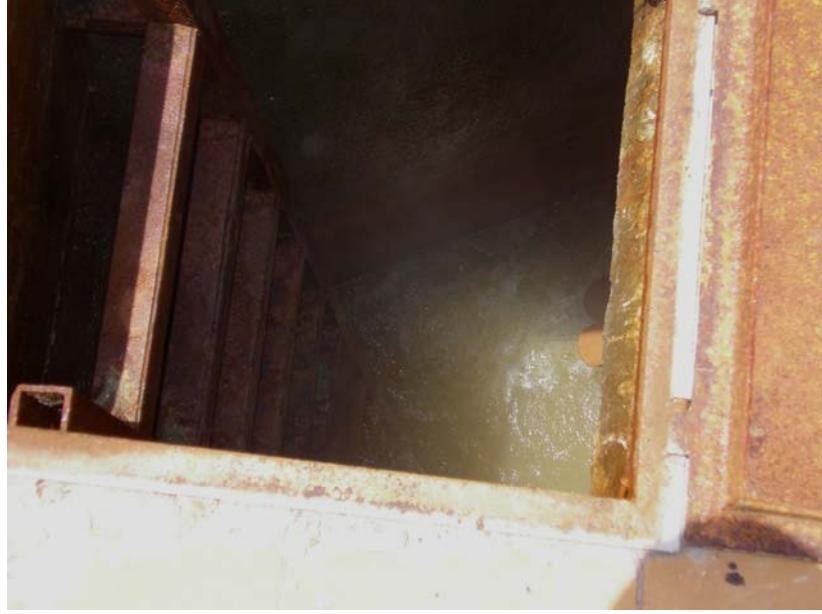
Şekil 6.43. Alangüllü termal tesisi depo bölümüne radon gazı ölçümleri için yerleştirilmiş Kodak LR 115 tip 2 katihal iz kazıma dedektörü (Orijinal, Mayıs 2009)
