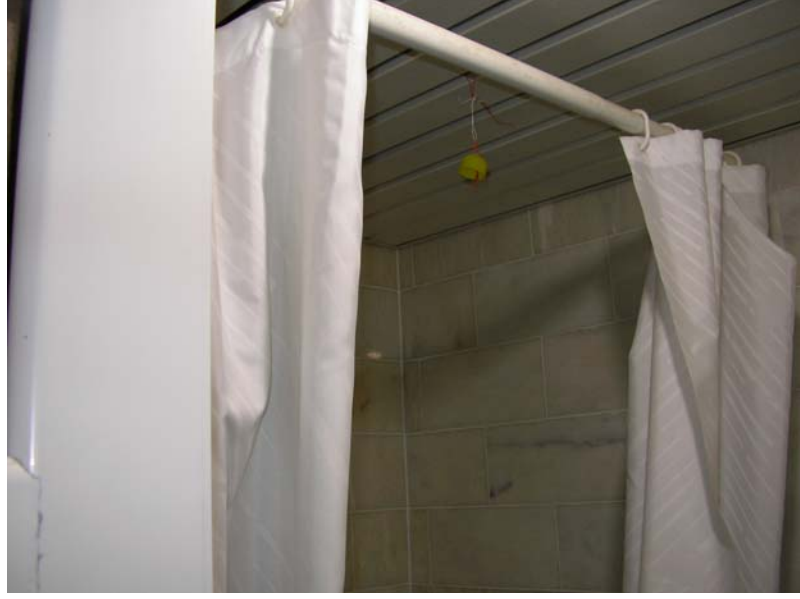
Şekil 6.39. Radon gazı ölçümleri için Kodak LR 115 tip 2 katıhal iz kazıma dedektörünün otel odası banyosuna yerleştirilmesi (Orijinal, Nisan 2009)
