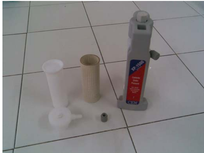
Resim 3.9 Mikrodalga yağ yakma teflon tüp seti (teflon kapak ve tüp, silindirik dış zırhı, taşıyıcı ünitesi).
