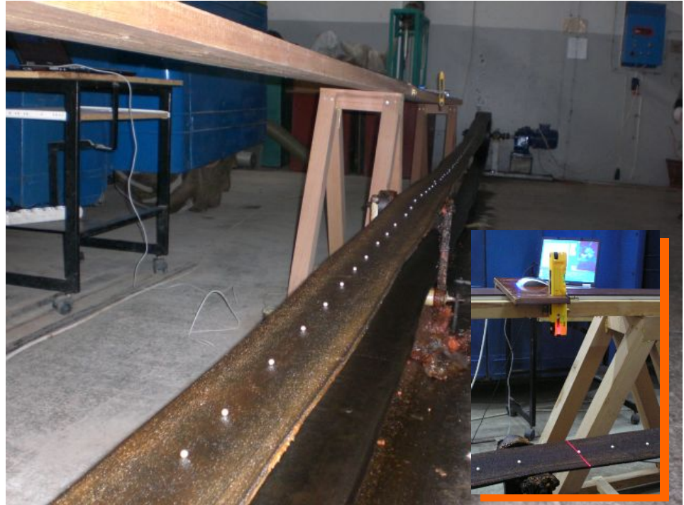
Şekil 4.76. 8 mm çaplı küresel materyal ile yapılan yapışkan bant denemesinden bir görünüm
