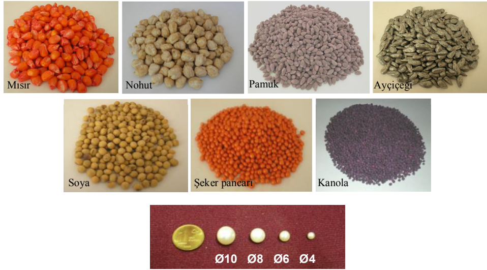
Şekil 3.6. Denemelerde kullanılan tohumlar ve küresel materyaller
