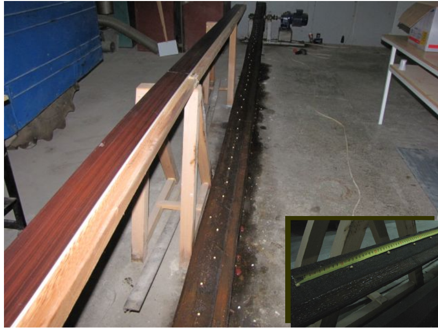
Şekil 4.36. Soya tohumuyla yapılan yapışkan bant denemesinden bir görünüm
