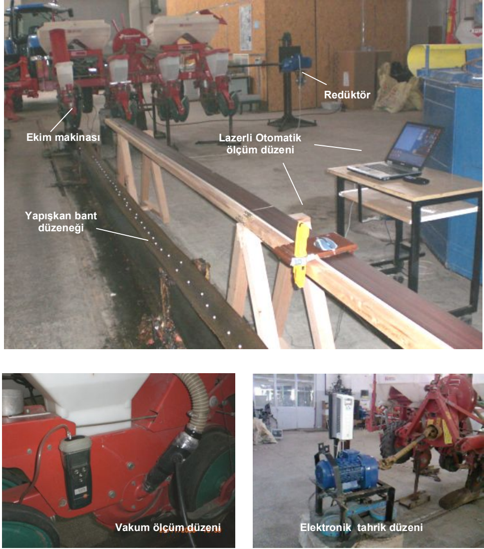
Şekil 3.7. Ekim makinası deneme düzeni
