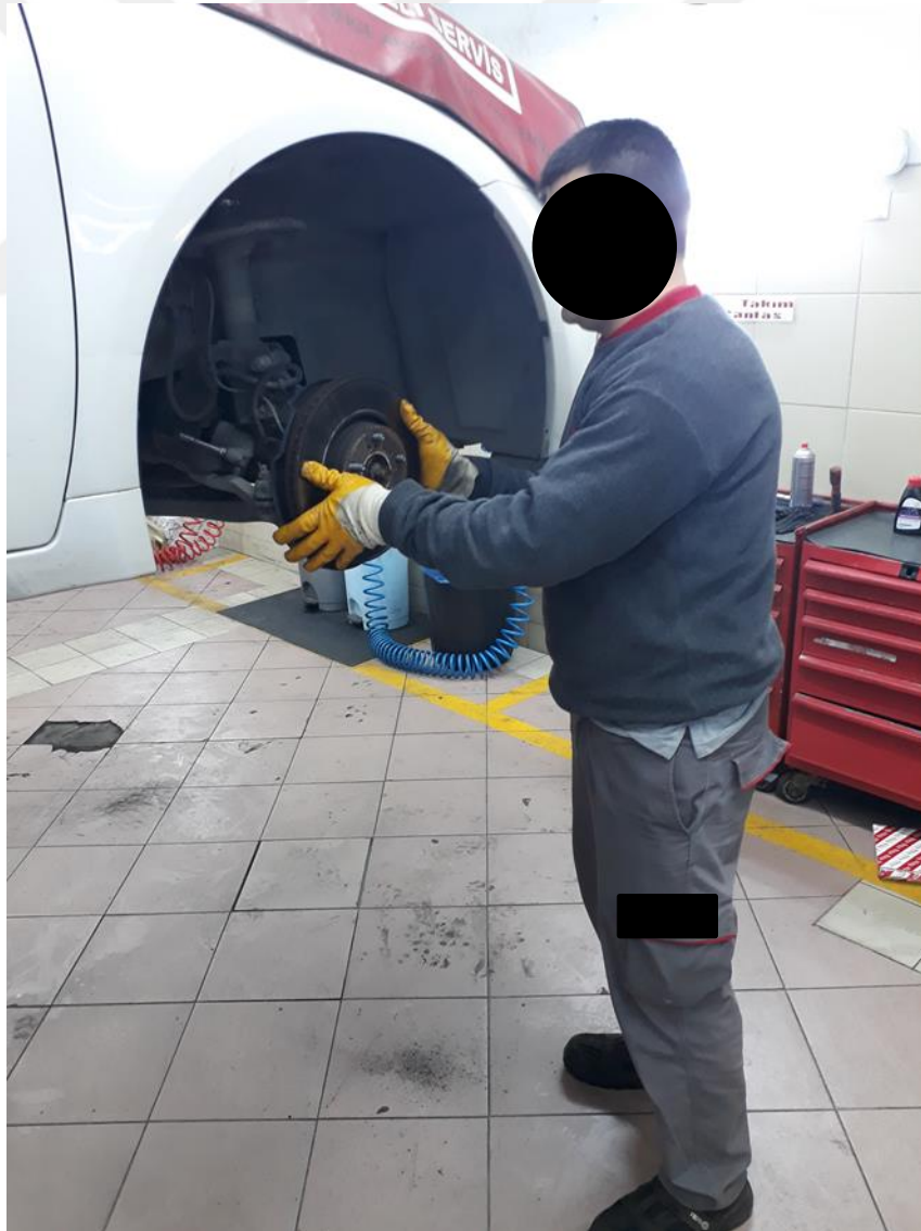
Şekil 12. Fren diskinin kaldırılması ve tutularak yerine sabitlenmesi
