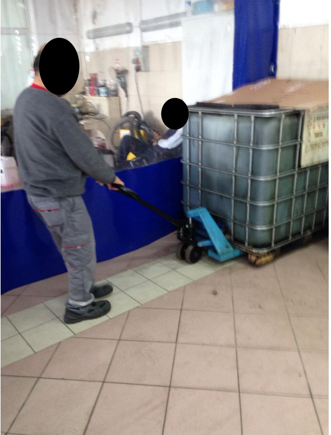
Şekil 15. Atık motor yağı deposunun transpalet ile taşınması
