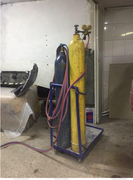
Şekil 12.Oto Sanayi Sitelerinde Risk Etmenleri Olarak Değerlendirilen Gaz Tüpleri
