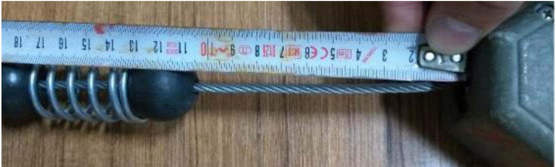
Şekil 144: 1.5 Metrelik Otomatik Düşüş Durdurucunun Devreye Girdiği An (68 cm)
