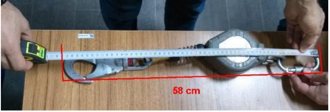
Şekil 142: 1.5 metrelik Otomatik Düşüş Durdurucunun Ortalama Boyu (58 cm)
