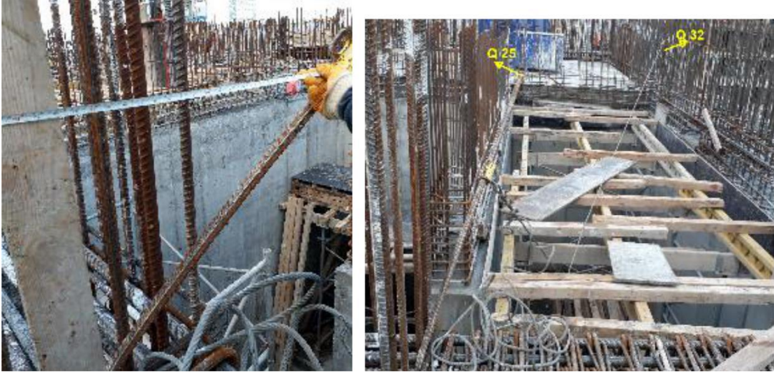
Şekil 107: 1.Ankraj Eğilme Ölçüm (25cm) Şekil 108: Test Sonrası Mevcut Durum
