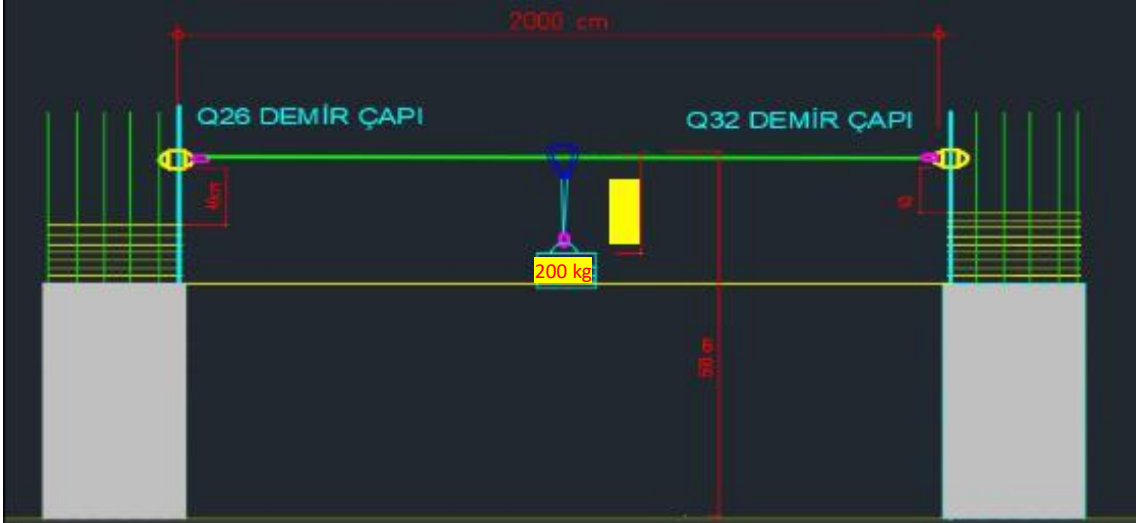
Şekil 52: Çapı 26 Olan Demir Filizi Ankraj Testi Proje Çizim
