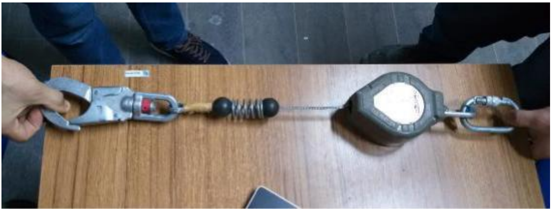
Şekil 144: 1.5 Metrelik Otomatik Düşüş Durdurucunun Devreye Girdiği An (68 cm)
