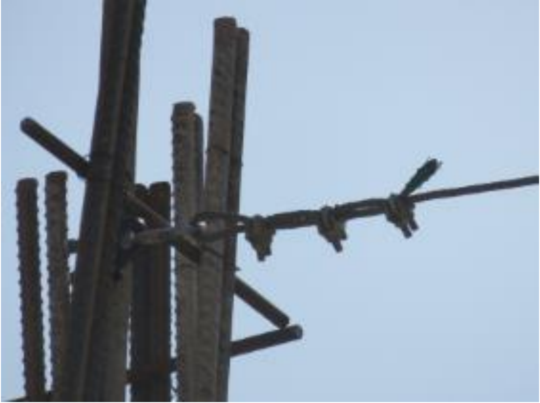
Şekil 128: Ankraj Testi Sonrası Demir Filizleri ve Askıda Kalan Yük Durumu
