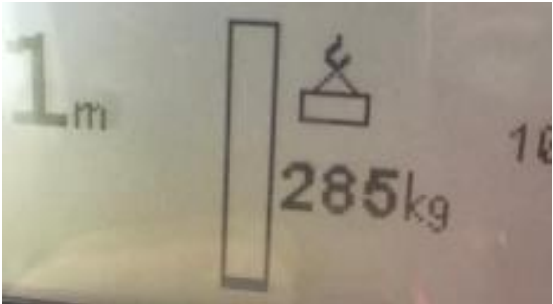
Şekil 25: Kule Vinç Ağırlık Ekranında 200 kg Ağırlığın Ölçüsü (285-85: 200kg)
