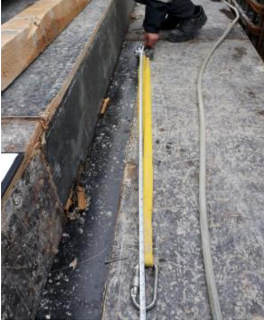
Şekil 51: Çapı 25 ve 30 Olan Demir Filizi Ankraj Testi Proje Çizim
