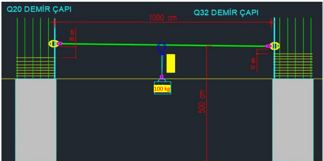
Sekil 33: Çapı 20 ve 32 Olan Demir Filizi 2. Ankraj Testi Proje Çizimi
