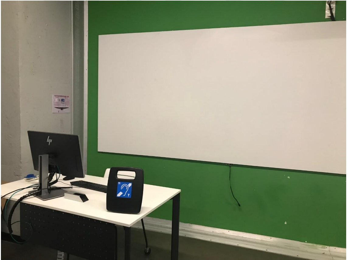
Öğrenme ortamında kullanılan taşınabilir İndüksiyon Döngü Sistemi
