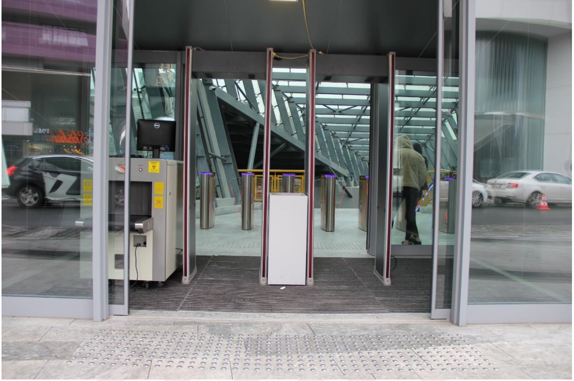
Cadde Giriş Kapısı – Görme engelliler için uyarıcı yüzey uygulaması
