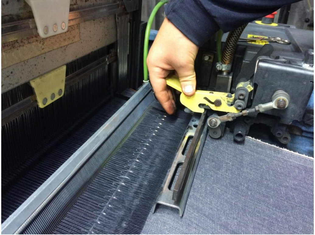
Şekil 29: Çalışan tezgahta arızalı sensöre elle müdahale etme
