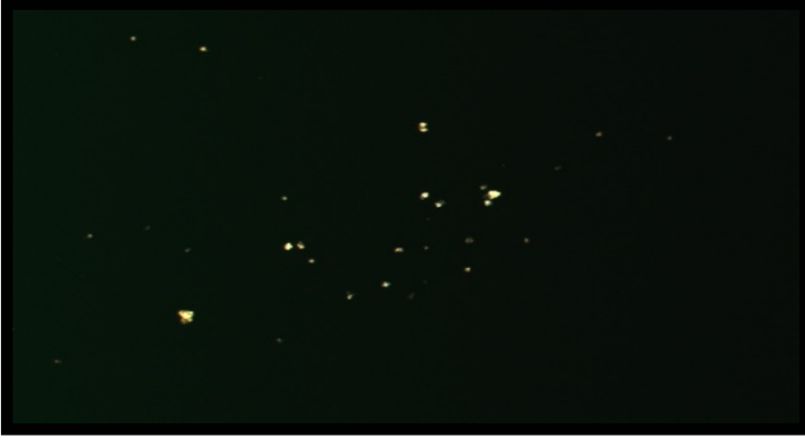
Şekil 4.24 MTS konjuge CdSe/CdS kuantum dotların 5X büyütmede Floresans mikroskobu görüntüsü.
