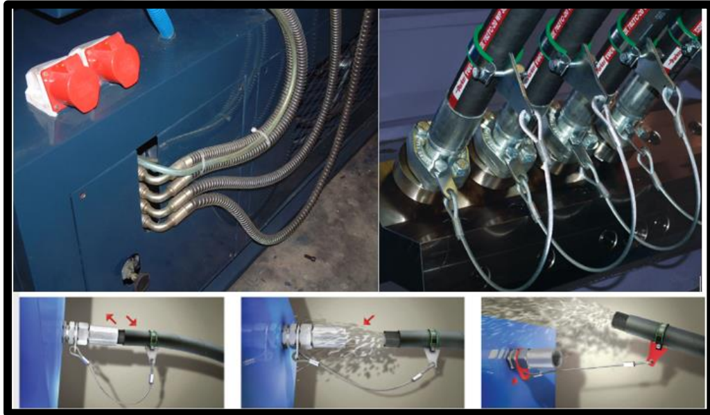
Resim 28: Hidrolük hortumların tehlikeleri ve emniyete alınması (HOSEASSEMBLYTİPS, 10.03.2018)
