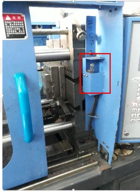
Resim 13: Hareketli operatör emniyet kapısı ve ön kapı siviçi
