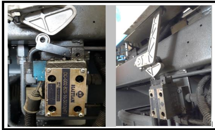
Resim 21: Operatör karşı taraf hidrolik-mekanik emniyet valfi
