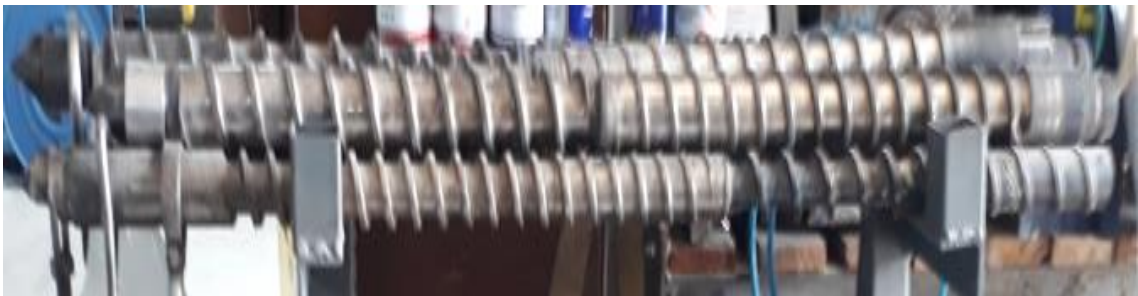
Resim 2: Plastik enjeksiyon makine 3 tip profile sahip vidalar
