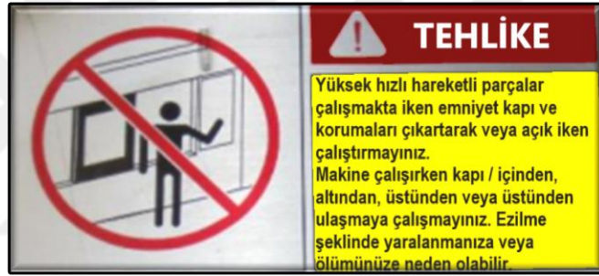
Şekil 11: Operatör çalışma alanı tehlike ikaz levhası
