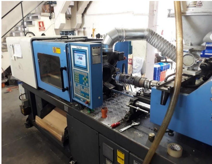
Resim 30: Plastik iřleme esnasında oluřan gazların alıřma ortamından uzaklařtırılması
