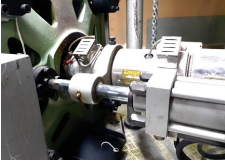
Resim 6 Silindir ocak memesi-kaliba dayama
