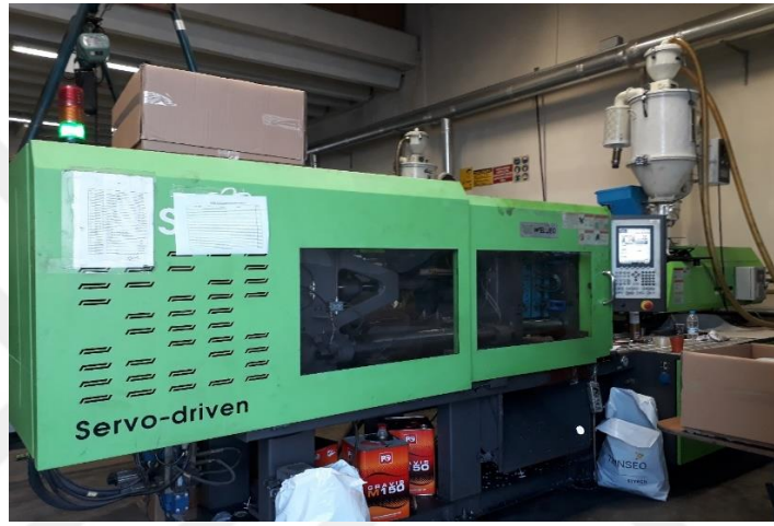
Resim 19: Operatör tarafı /Operatör karşı tarafı güvenlik kapısı ve camları
