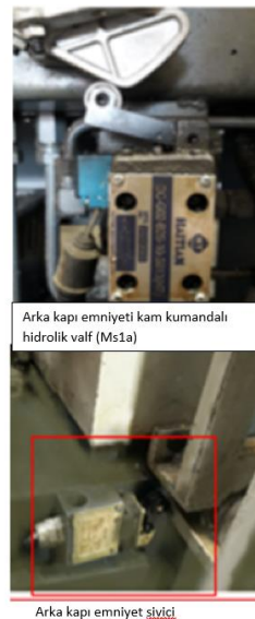
Resim 9: Yatay enjeksiyon plastik kalıplama makinesi arka görünüş tehlike noktaları
