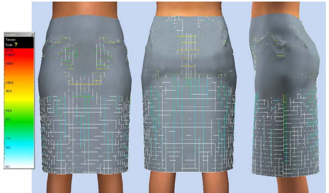
Şekil 7.18 Metrik Kalıp Hazırlama Sistemi'nde hazırlanan eteğin, alt kum saati vücut tipine sanal giydirmesinin gerilim haritası görüntüleri.
