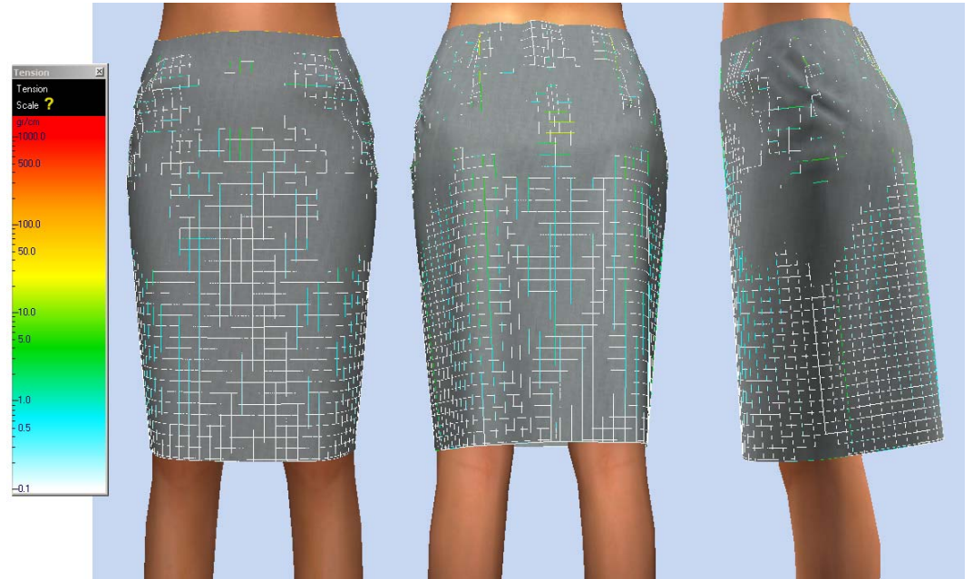
Şekil 7.75 Contec Kalıp Hazırlama Sistemi'nde hazırlanan eteğin, dikdörtgen vücut tipine sanal giydirmesinin gerilim haritası görüntüleri.
