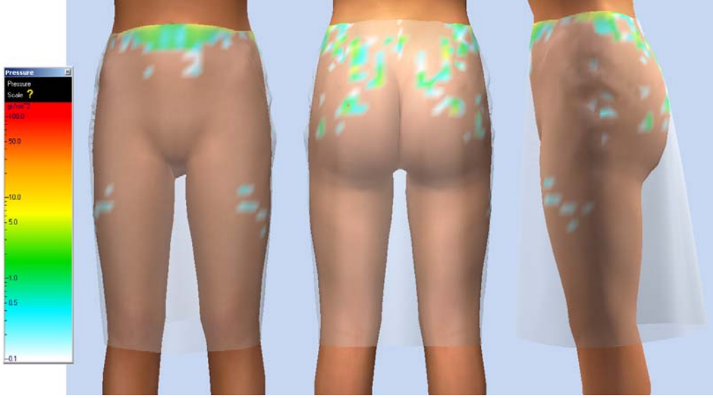
Şekil 7.26 Contec Kalıp Hazırlama Sistemi'nde hazırlanan eteğin, üst kum saati vücut tipine sanal giydirmesinin basınç haritası görüntüleri.
