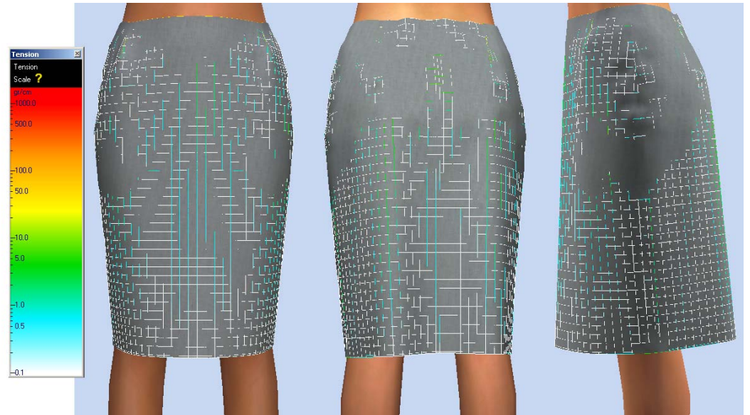
Şekil 7.3 Contec Kalıp Hazırlama Sistemi'nde hazırlanan eteğin, kum saati vücut tipine sanal giydirmesinin gerilim haritası görüntüleri.
