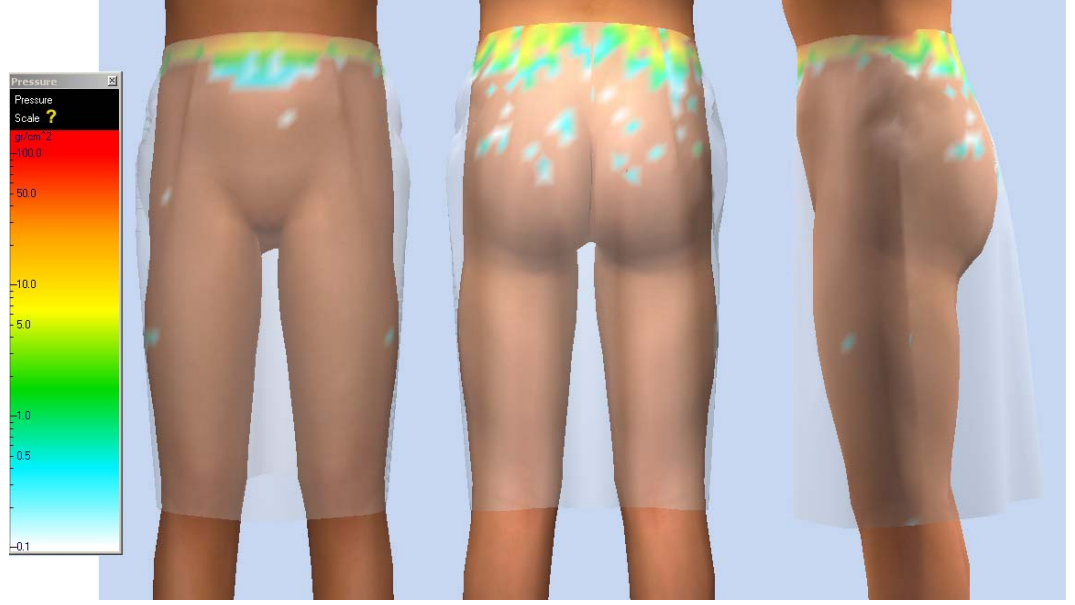
Şekil 7.71 Temel Bloklar Kalıp Hazırlama Sistemi'nde hazırlanan eteğin, ters üçgen vücut tipine sanal giydirmesinin basınç haritası görüntüleri.
