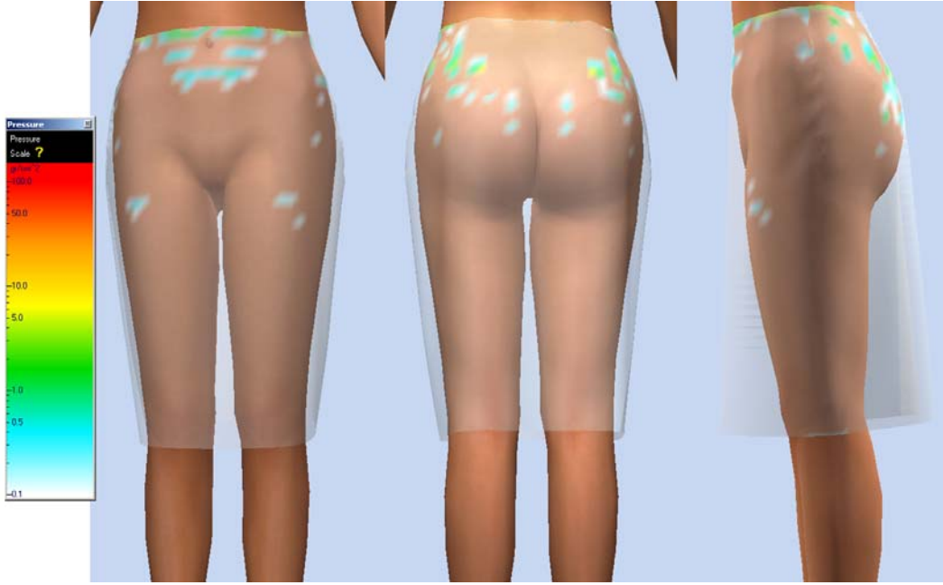
Şekil 7.41 Metrik Kalıp Hazırlama Sistemi'nde hazırlanan eteğin kaşık vücut tipine sanal giydirilmesinin basınç haritası görüntüleri.
