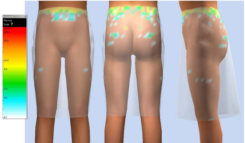
Şekil 7.65 Metrik Hazırlama Sistemi'nde hazırlanan eteğin, ters üçgen vücut tipine sanal giydirmesinin basınç haritası görüntüleri.
