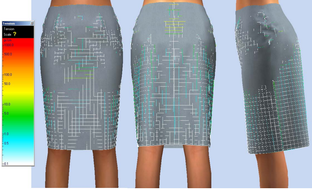
Şekil 7.84 Temel Bloklar Kalıp Hazırlama Sistemi'nde hazırlanan eteğin, dikdörtgen vücut tipine sanal giydirmesinin gerilim haritası görüntüleri.
