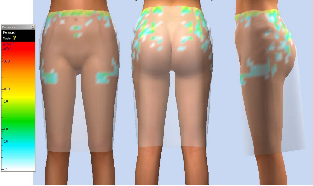
Şekil 7.59 Temel Bloklar Kalıp Hazırlama Sistemi'nde hazırlanan eteğin, üçgen vücut tipine sanal giydirmesinin basınç haritası görüntüleri.
