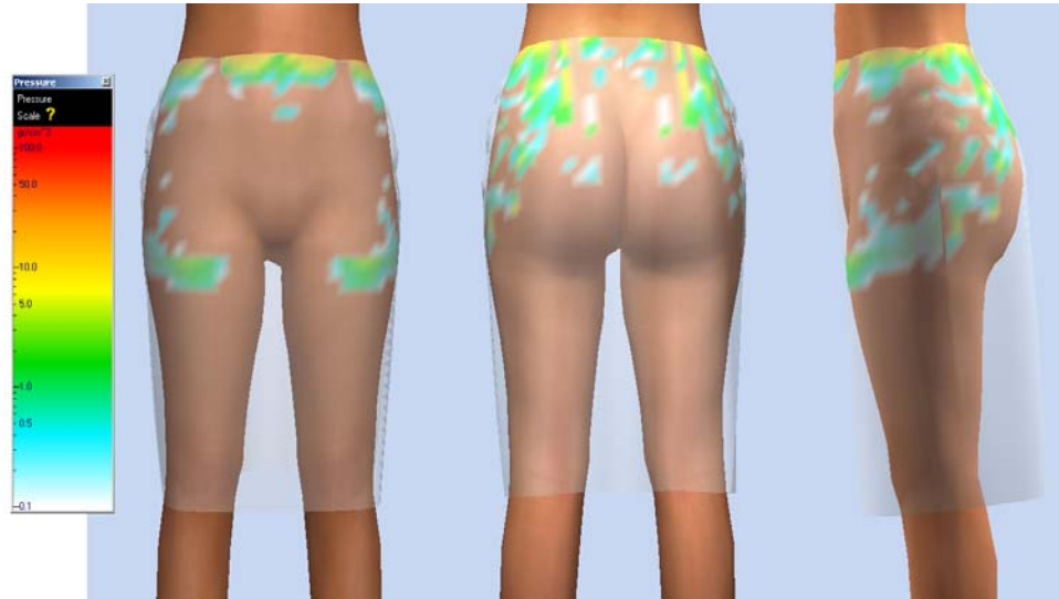
Şekil 7.11 Temel Bloklar Kalıp Hazırlama Sistemi'nde hazırlanan eteğin, kum saati vücut tipine sanal giydirmesinin basınç haritası görüntüleri.
