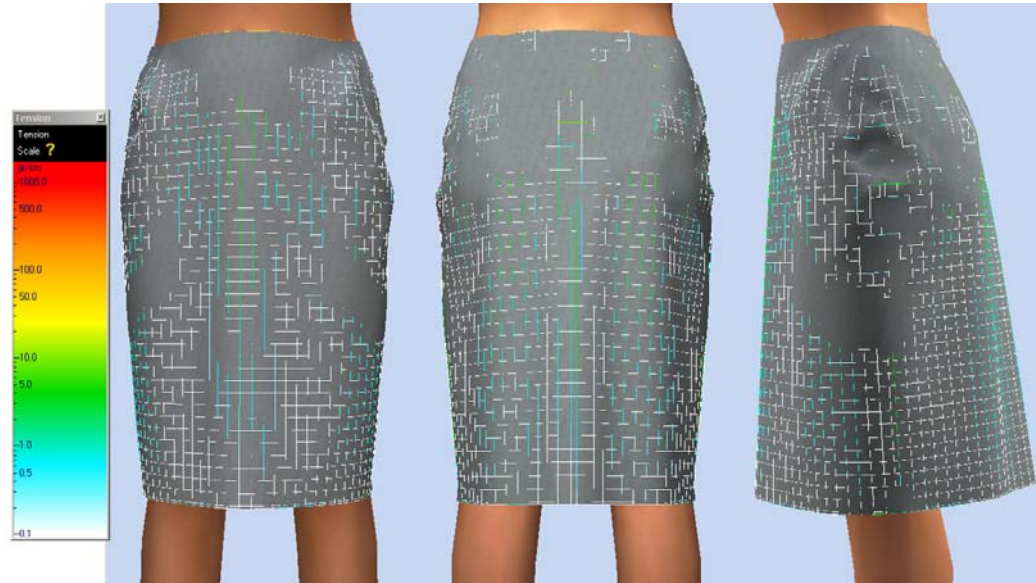
Şekil 7.27 Contec Kalıp Hazırlama Sistemi'nde hazırlanan eteğin, üst kum saati vücut tipine sanal giydirmesinin gerilim haritası görüntüleri.
