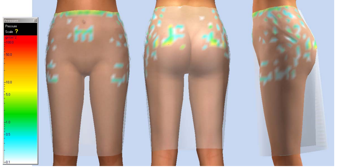
Şekil 7.74 Contec Kalıp Hazırlama Sistemi'nde hazırlanan eteğin, dikdörtgen vücut tipine sanal giydirmesinin basınç haritası görüntüleri.
