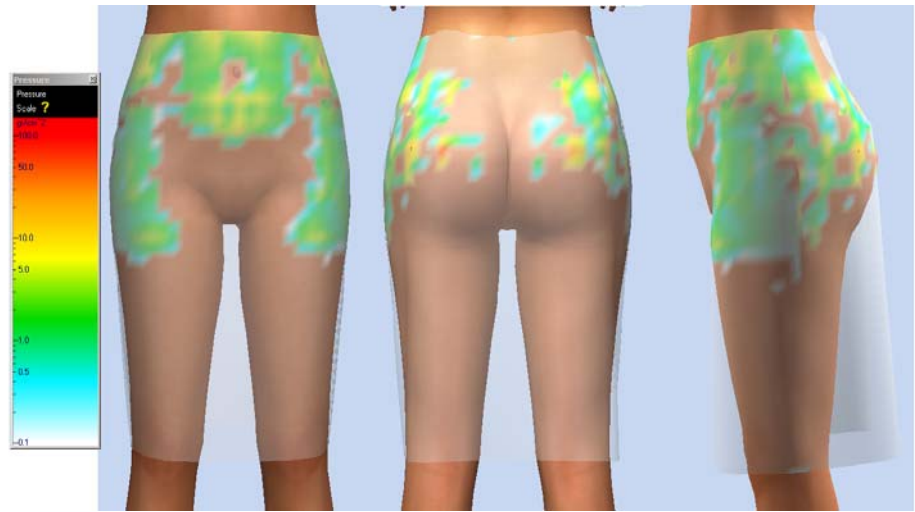
Şekil 7.44 Müller Kalıp Hazırlama Sistemi'nde hazırlanan eteğin kaşık vücut tipine sanal giydirmesinin basınç haritası görüntüleri
