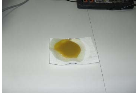
Şekil 7.8 Süzildükten sonra filtrede kalan magnezyum silikat kek tabakası
