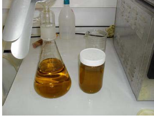
Şekil 7.9 Kuru yıkama yapıldıktan ve vakumlu süzme işleminden sonra elde edilen PYME
