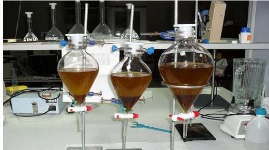
Şekil 7.5 Reaksiyonun sonlanmasından itibaren 8 saatlik bekleme sürecinde gliserin-metil ester faz ayrımı
