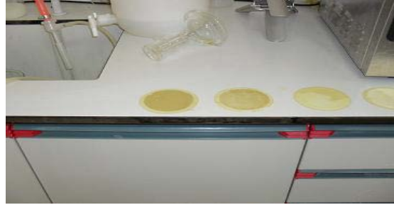
Şekil 7.12 Süzildükten sonra filtrede kalan zeolit kek tabakası
