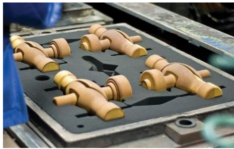
Şekil 14: Kalıpta maçanın görünümü (Foundrymag, 2019)
