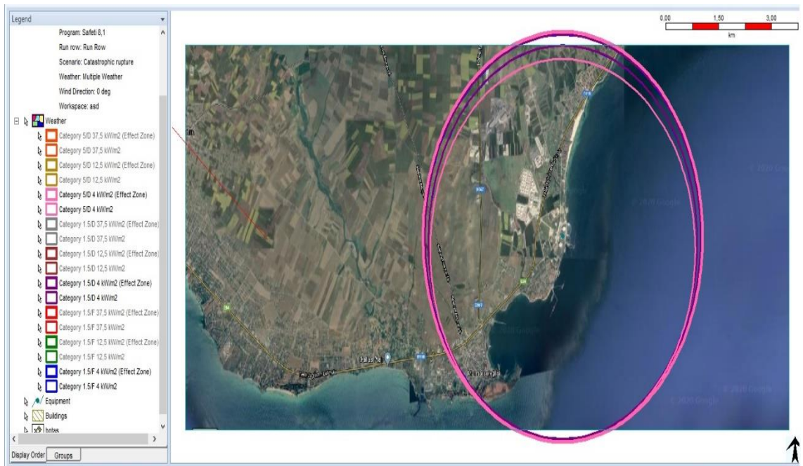
Şekil 30: Bir LNG depolama tankında olası katastrofik patlama senaryosunda, geç oluşan havuz yangının radyasyon yoğunluğu yarıçapı
