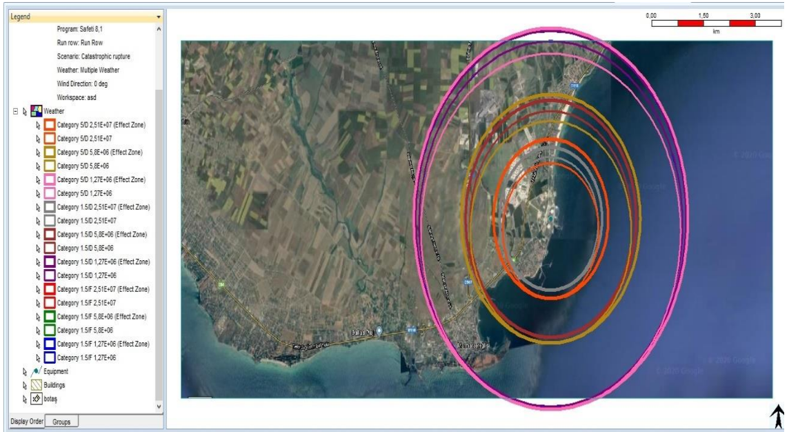
Şekil 35: Bir LNG depolama tankında olası katastrofik patlama senaryosunda, geç oluşan havuz yangınların radyasyon doz yarıçapı
