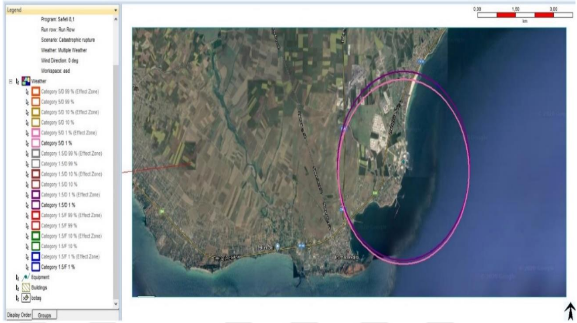
Şekil 33: Bir LNG depolama tankında olası katastrofik patlama senaryosunda, geç oluşan havuz yangının mortalite yarıçapı
