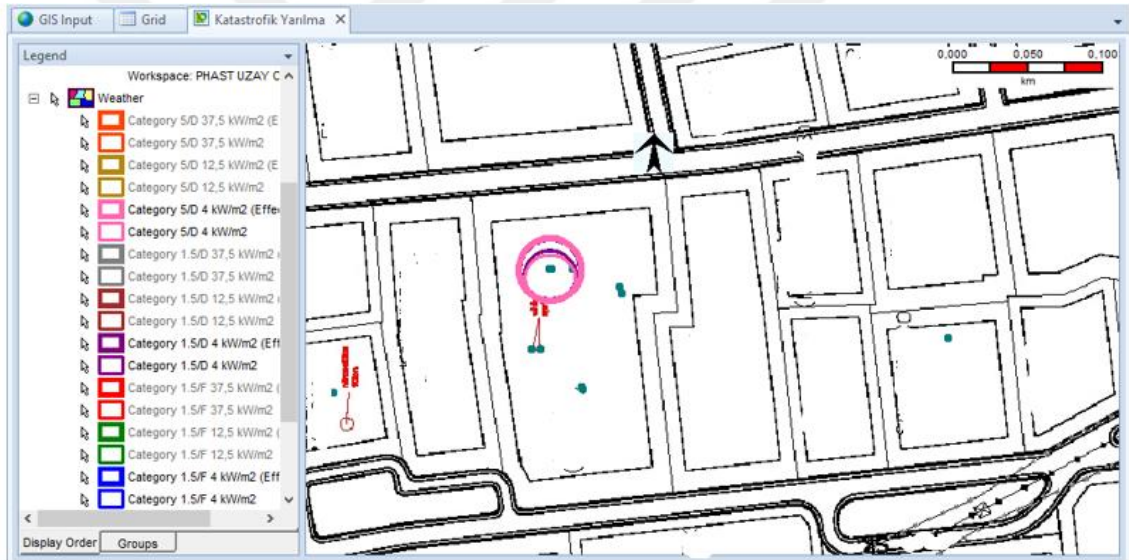
Şekil 196:GA Tesisi Yağ Varili 200 Lt-Katastrofik Yarılma-En Kötü Senaryo Geç Havuz Yangını Etkisi Kuş Bakışı Görünüm
