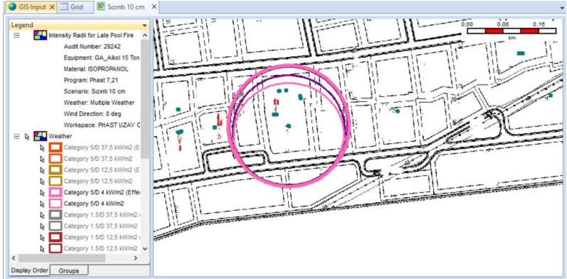
Şekil 192:GA Tesisi Alkol 15 Ton İbc'ler-Sızıntı(10 Cm)-En Kötü Senaryo Geç Havuz Yangını Etkisi Kuş Bakışı Görünüm
