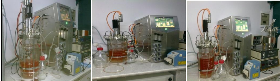
Şekil 3.14 5A8 hibridoma kültürünün %10 (v/v) serum içeren ortamda karıştırılmalı tank biyoreaktörde ölçek büyütme işlemi.
