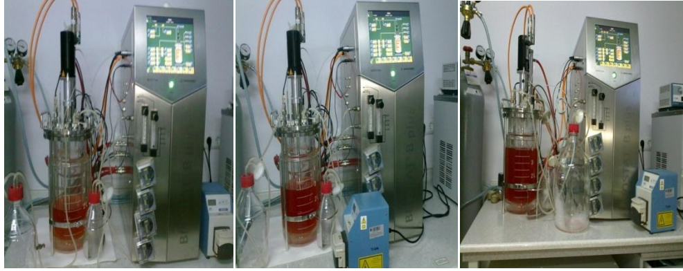
Şekil 3.15 5A8 hibridoma kültürünün %10 (v/v) serum içeren ortamda karıştırmalı tank biyoreaktörde ölçek büyütme işleminde 2L'den 4L'ye hacim artışı.
