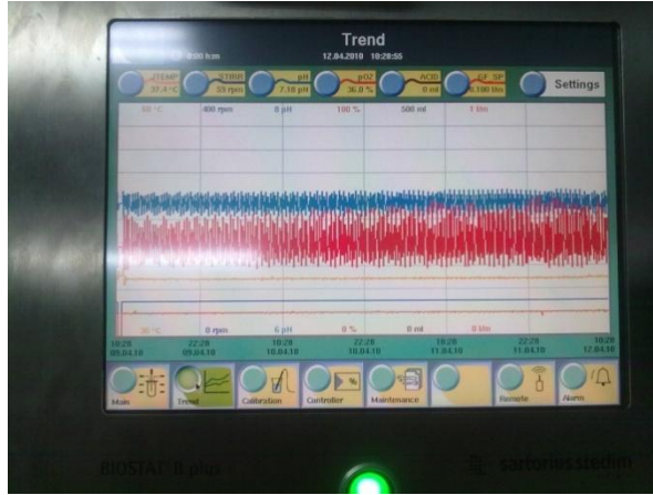
Şekil 3.8 Miyeloma hücreleri ile yapılan üretimde pH (mavi çizgiler) ve pO2 (kırmızı çizgiler) değerlerinde meydana gelen dalgalanmalar.
