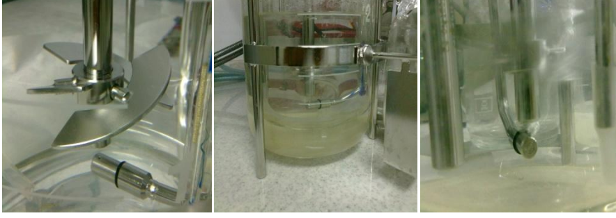
Şekil 3.13 Kullanılan makroparger'in otoklav sonrası fizyolojik su içerisindeki görünümü. Hava kabarcıkları karıştırıcıya çarpıp dağılmaktadır (sağda).
