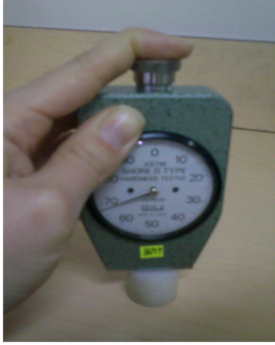
Şekil 5.2 PA 6 Shore D sertlik ölçümü.
