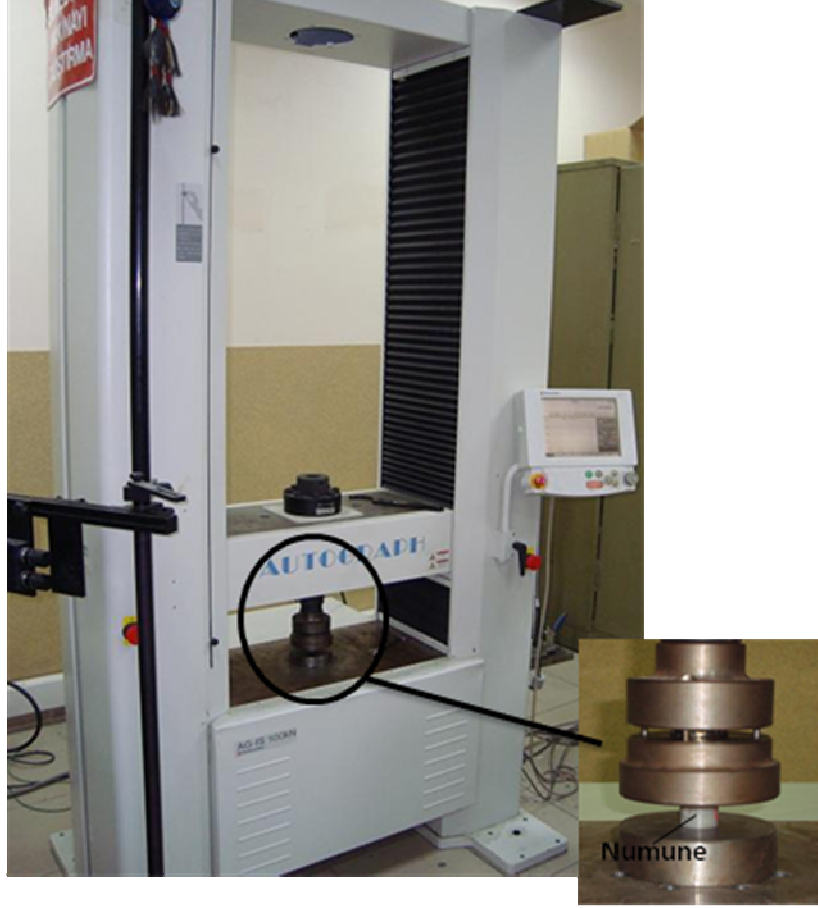
Şekil 5.3 SHIMADZU AG-IS marka basma deney cihazı.
