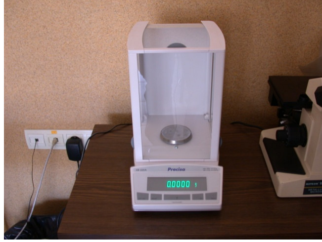
Şekil 5.6 Precisa XB 220A hassas terazi.
