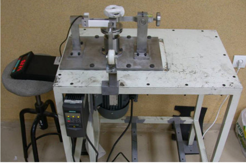
Şekil 5.4 Aşınma testinin yapıldığı aşınma cihazının fotoğrafı.
