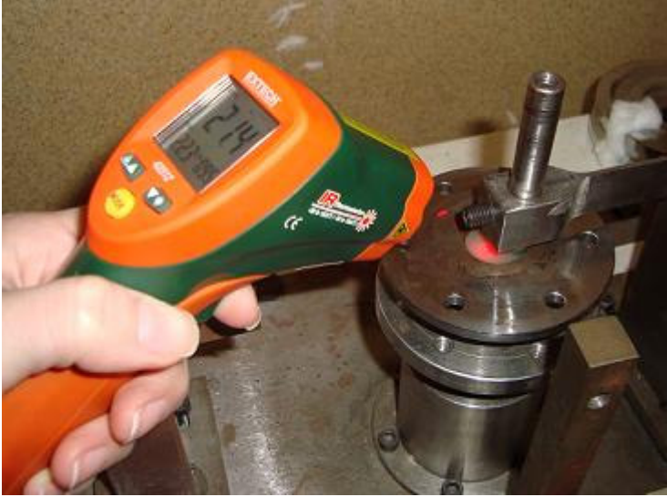
Şekil 5.7 EXTECH 42512 hassas ölçümler için çift lazerli infrared termometre.
