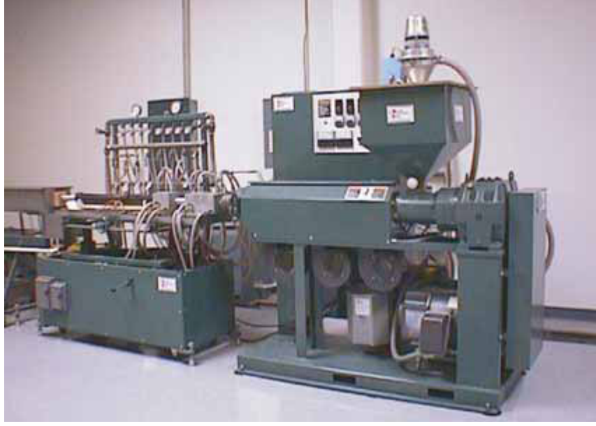
Şekil 2.2 Plastik ekstrüzyon makinesi (Sayer ve Özkan, 2007)
