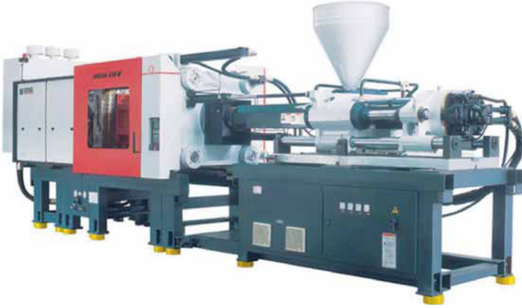
Şekil 2.3 Plastik enjeksiyon kalıplama makinesi (Sayer ve Özkan, 2007)
