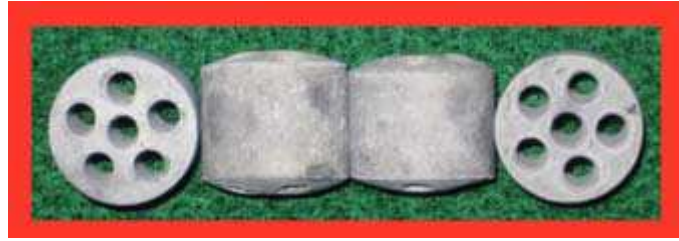
Şekil 4.14 BASF firmasının SG – 9301 Buharlı Yakıt Dönüştürücü katalisti, Ölçüler ; Dış Çap= 16 mm X Boy = 16 mm, Delik Çapı = 3.5 mm, 6 adet Delik (BASF, 2010).
