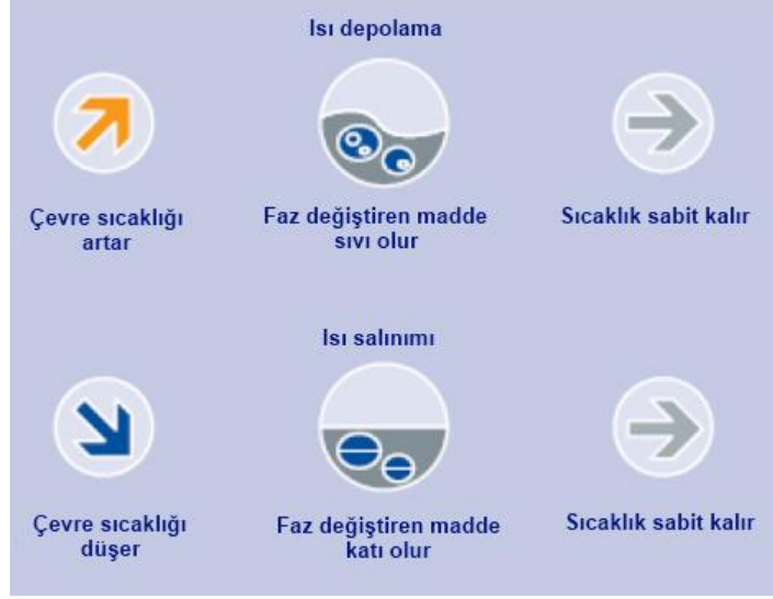
Şekil 5.1 FDM 'nin oda sıcaklığında tepki fonksiyonu (Cosco'dan, 2006).
