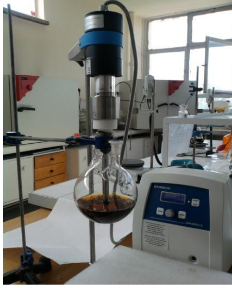
Şekil 3.2. Ultrasonik ekstraksiyonların uygulama şekli.
