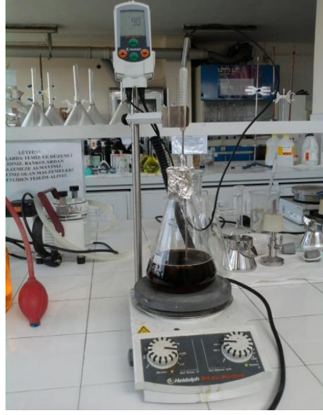
Şekil 3.1. Geleneksel ekstraksiyonların uygulama şekli.
