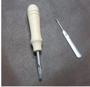
Resim 2.20. Kenar alma ve düz linol bıçağı
