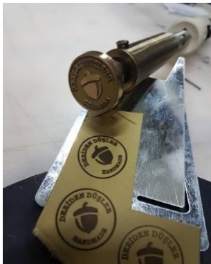
Resim 2.52. Kişiyözel logo tasarımının havayla sıcak baskı olarak deriye uygulanması
