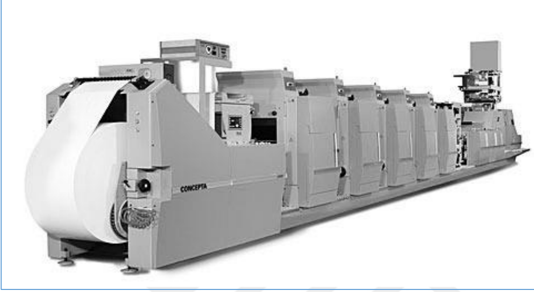
Resim 2.9. Web ofset baskı makinası (İnternet-17)
