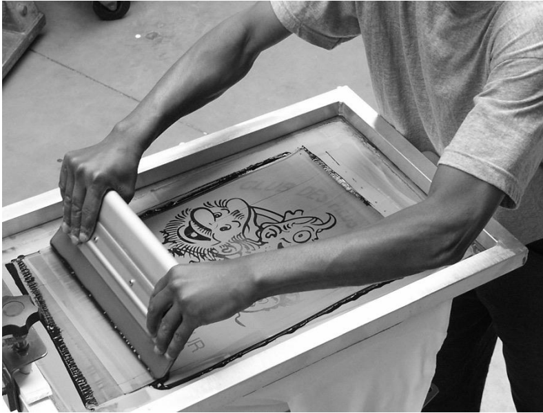
Resim 2.11. Serigrafi baskı tekniği uygulaması (İnternet-19)
