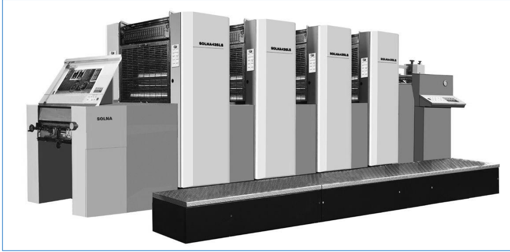
Resim 2.10. Tabaka ofset makinası (İnternet-18)
