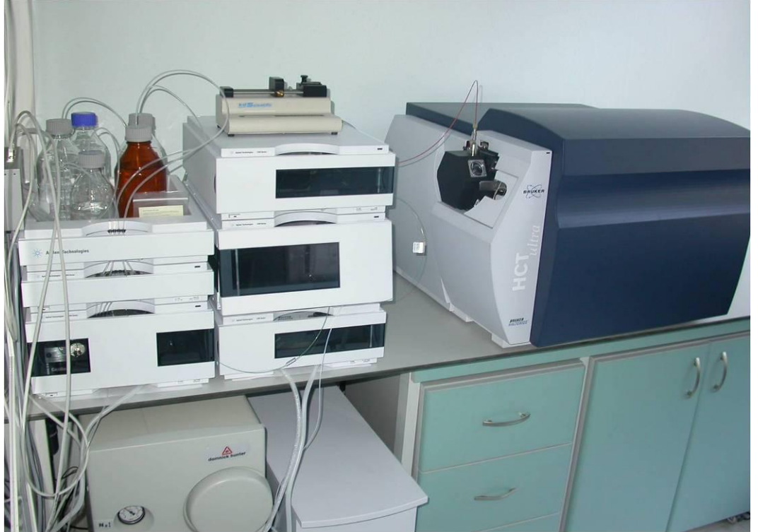
Şekil 2.4: Kapiler HPLC - Elektro Sprey İyonizasyon - Kütle Spektroskopisi.
