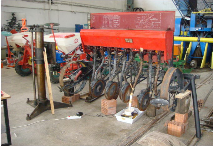
Şekil 3.5. Üstten akışlı Büyük çaplı oluklu ekici makaraya sahip tahıl ekim makinası
