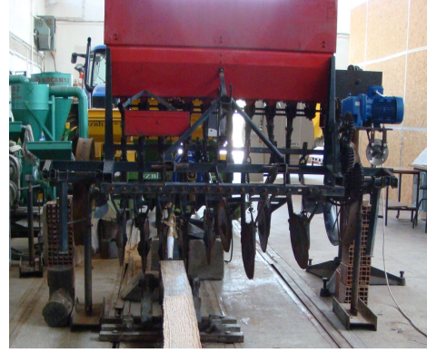
Şekil 3.29 b. Büyük çaplı oluklu makaralı normal sıraya ekici düzende yapışkan bant denemeleri.
