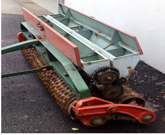
Şekil 3.2. Alttan Akışlı Oluklu Makaralı (Brillon) Ekici Düzen
