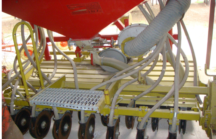
Şekil 3.17. Tohum borusu olarak kullanılan uzun plastik hortumlar ve diskli gömücü ayaklar
