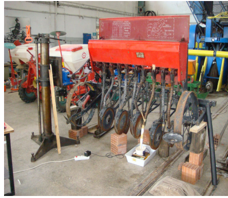
Şekil 3.27 b. Büyük çaplı oluklu makaralı normal ekim makinasında tartım denemesi.
