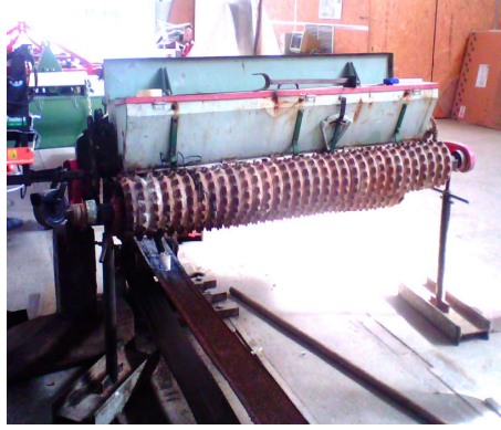
Şekil 3.29 a. Oluklu makaralı (Brillon) ekim makinasında yapışkan bant denemeleri.
