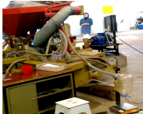
Şekil 3.27 b. Büyük çaplı oluklu makaralı normal ekim makinasında tartım denemesi.
