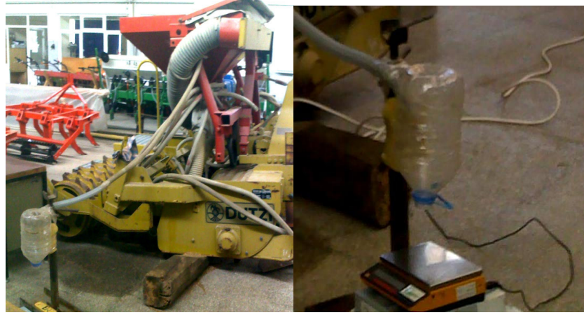
Şekil 3.28. Tohum akış düzgünlüğünün sağlanması için kullanılan siklon
