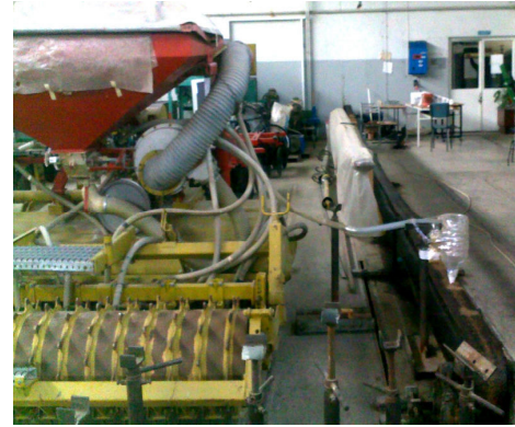
Şekil 3.29 d. Pnömatik normal sıraya ekici düzende yapışkan bant denemeleri
