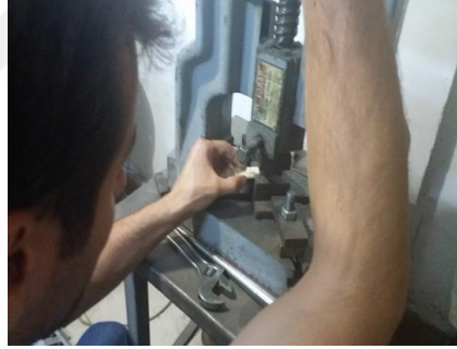
Resim 4.78. Kalıpların pres yardımıyla çıkarılması.
