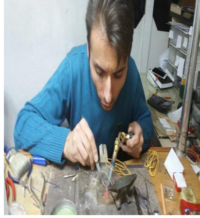
Resim 4.39. Altın tellerin iki ucunun birbirine kaynatılması.
