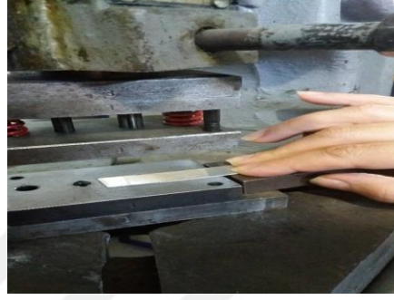
Resim 4.77. Kalıpların pres yardımıyla çıkarılması.
