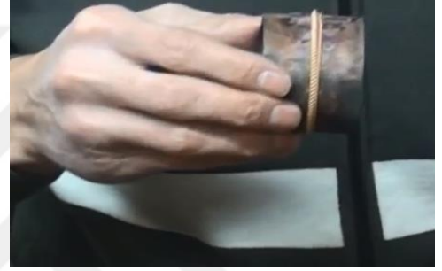
Resim 4.53. Altın halka tellerin bilezik kabına tutturulması.
