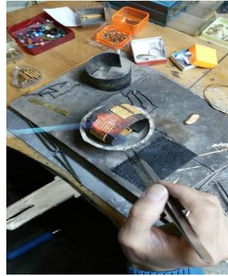
Resim 4.57. Kaşın bileziğe monteleme hazırlığı.
