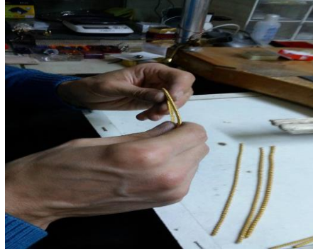
Resim 4.38. Altın tellerin belirli boyutlarda kesilerek iki ucunun birbirine bağlanması.
