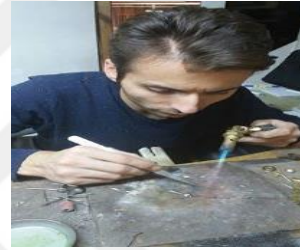
Resim 4.80. Menteşe kısmının kaynak yapılması.
