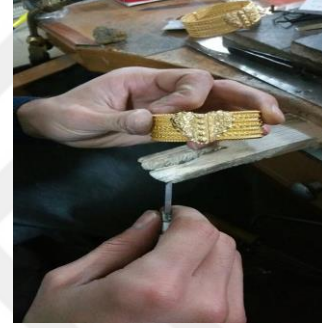
Resim 4.61. Bileziğin sürgü kilidine çivi şeklinde tel takılması.
