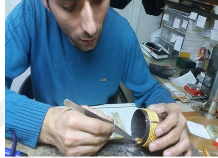
Resim 4.55. Sürgülü kilit yapımı.
