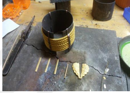
Resim 4.57. Kaşın bileziğe monteleme hazırlığı.
