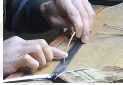
Resim 4.47. Altın telinin istenilen ölçülerde kesilmesi.
