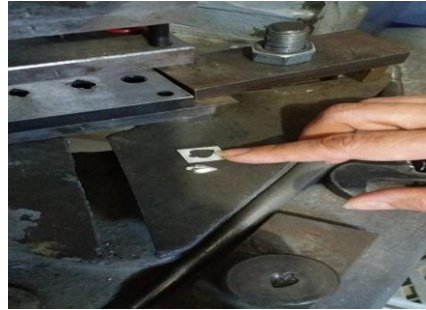
Resim 4.79. Kalıpların pres yardımıyla çıkarılması.
