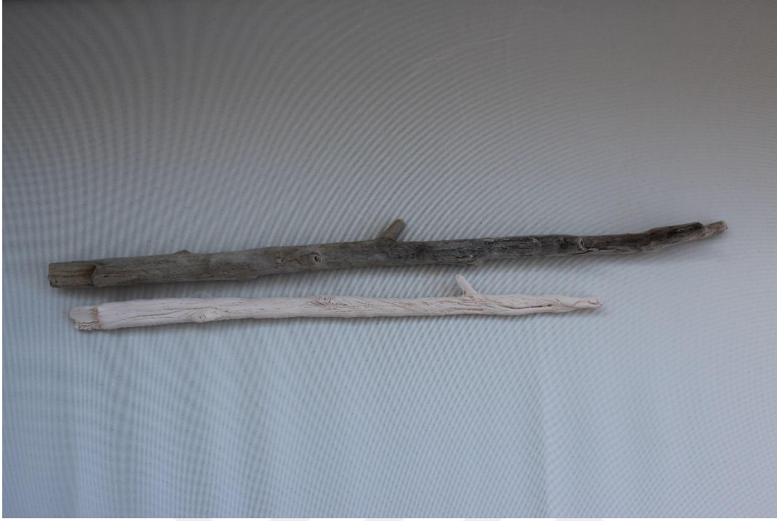
Resim 5.23. Üretim Aşaması 23, ESC1 Vakumlu beyaz kil 980°C’de pişirimi yapılmıştır. (URL 102)
