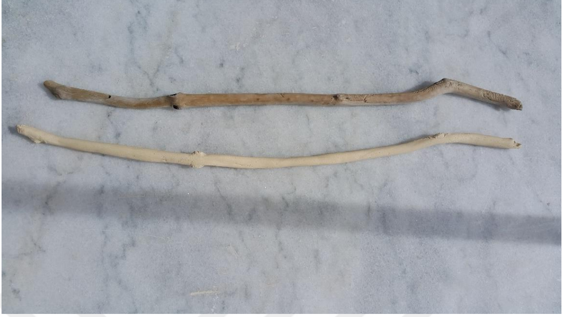
Resim 5.25. Üretim Aşaması 25, ESC 1 Vakumlu beyaz kil 1200°C’de pişirimi yapılmıştır. (URL 104)
