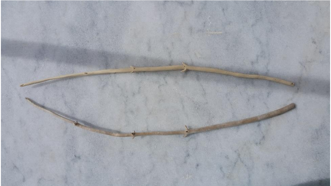
Resim 5.26. Üretim Aşaması 26, ESC 1 Vakumlu beyaz kil 1200°C’de pişirimi yapılmıştır. (URL 105)
