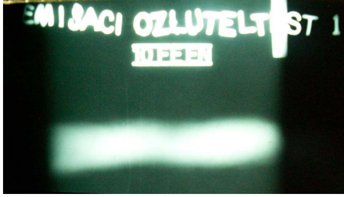
Şekil 4.8. PA pozisyonunda CO 2 koruyucu gazla kaynak edilen 1 nolu numunenin radyografik filmi
