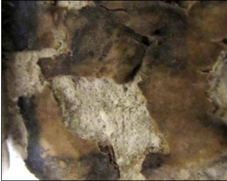
Resim 5.8. Hayvan tutkalından kaynaklanan kağıttaki kırılmalık
