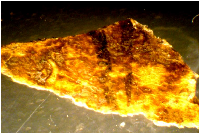
Resim 4.15. Kahverengi pigmentin üzerindeki hayvan tutkalının temizlikten sonraki mikroskop altı görünüşü
