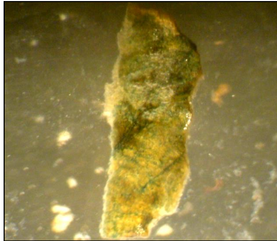
Resim 4.19. BaOH'in yeşil pigment ile reaksiyonunun mikroskop altı görünüşü
