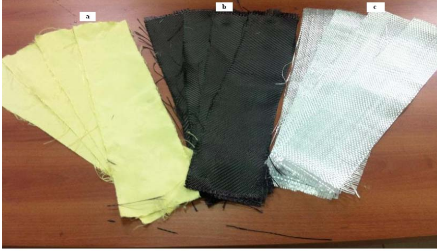
Şekil 5.2. Kullanılan kumaşlar soldan-sağa (a) Aramid elyaf, (b) Karbon elyaf, (c) Cam elyaf.
