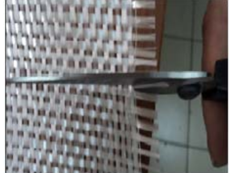
Şekil 5.1.Kompozit üretimi için kumaşların kesilmesi
