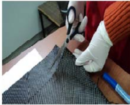
Şekil 5.1.Kompozit üretimi için kumaşların kesilmesi
