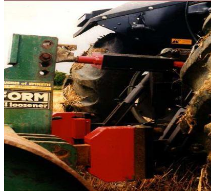
Şekil 1.20. Uzatılmış sekizgen halka dönüştürücüleri ve üstte algılayıcı sensör (Richards 2000).
