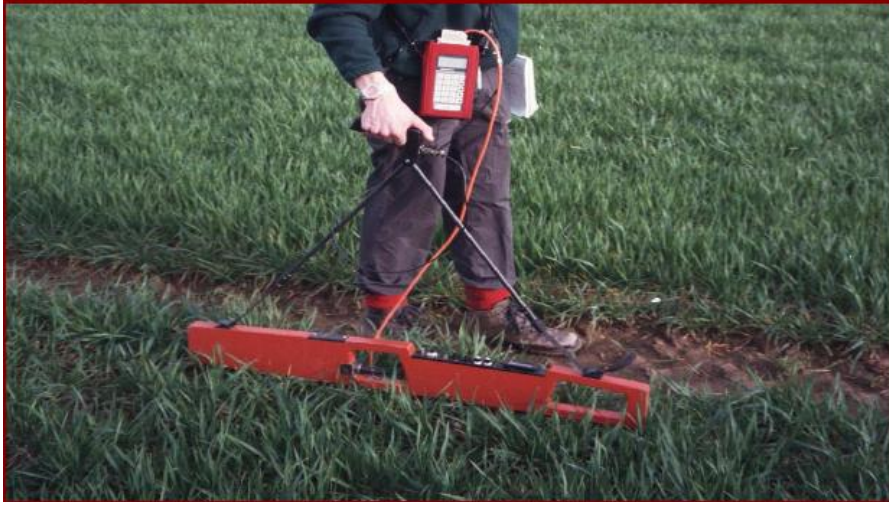
Şekil 1.15. Elektromanyetik indüksiyon (EMI) çalışması-EMI 38 (Waine 1999 ve Godwin 2003a).
