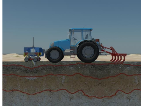
Şekil 4.1. Değişken derinlikte toprak işleme sisteminin simülasyonu.
