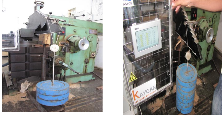
Şekil 3.11. Kalibrasyon için sensörün yüklenmesi.
