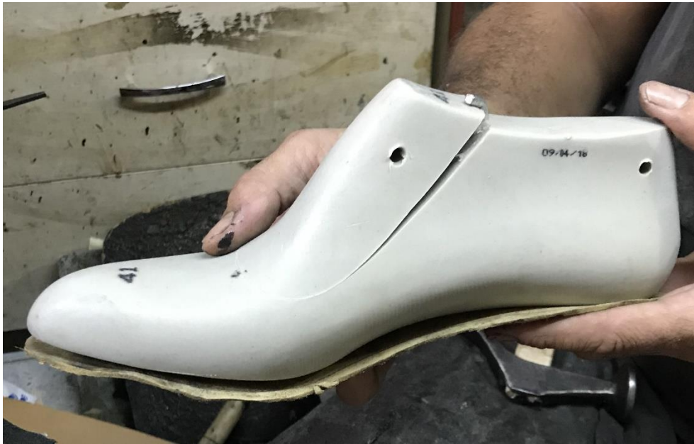
Resim 4.67. Taban astarının kalıba yerleştirilmesi
