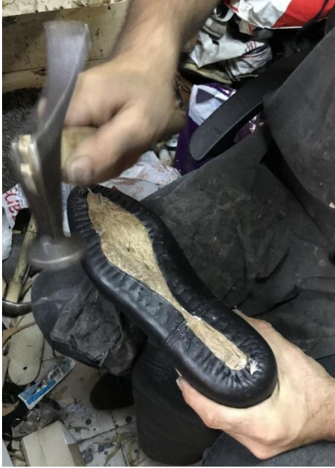
Resim 4.95. Taban dövme işlemi
