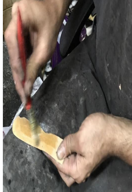
Resim 4.102. Topuk kamarasına yapıştırıcı sürülmesi
