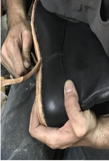
Resim 4.123. Topuğun ilk katının yapıştırılması
