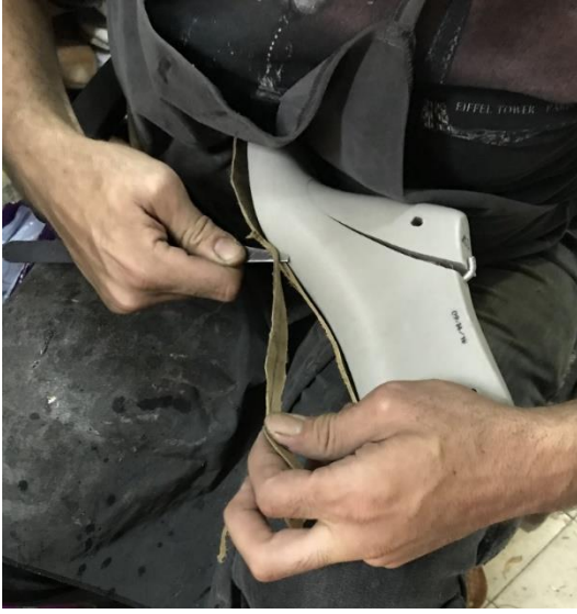
Resim 4.68. Taban astarının kesilmesi
