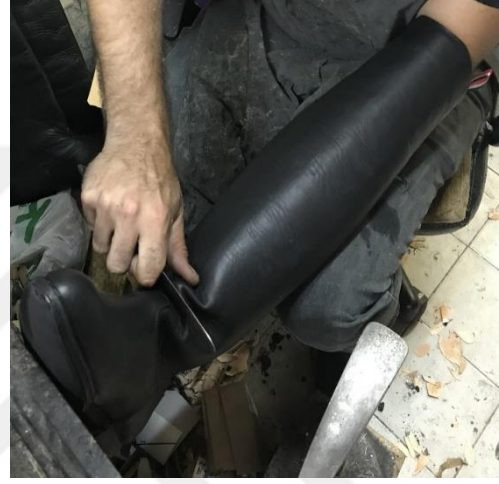
Resim 4.147. İlk körüğün oluşturulması
