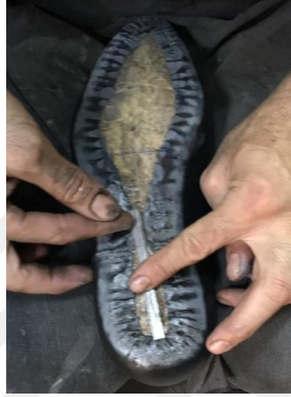
Resim 4.107. Kamara demirinin yerleştirilmesi
