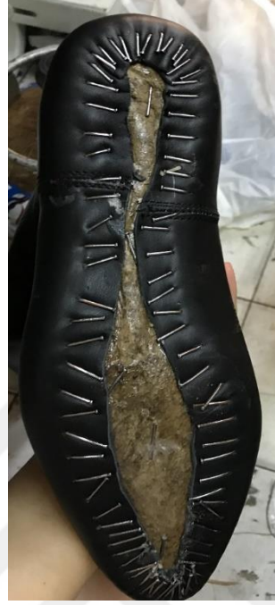
Resim 4.89. Sabitlenme işleminin tamamlanması
