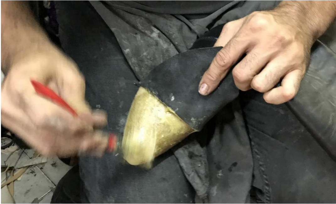
Resim 4.81. Silikon yapıştırıcının sürülmesi
