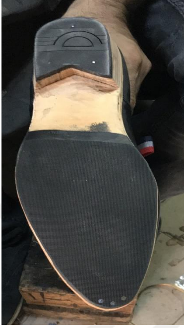
Resim 4.134. Topuk ve taban lastiklerine çivilerin çakılması
