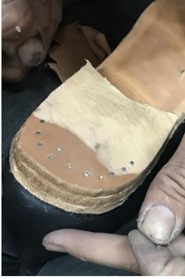
Resim 4.127. Kenar çivilerin çakılması
