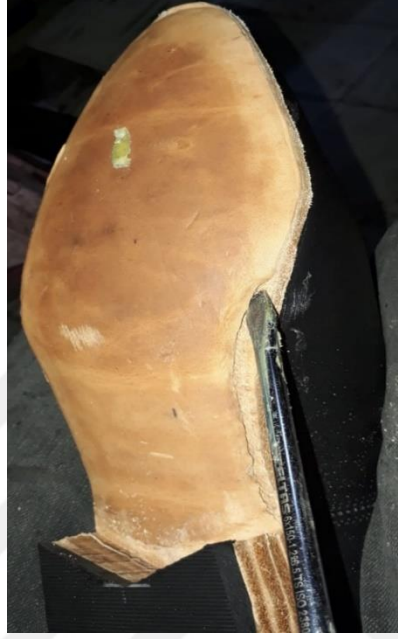
Resim 4.132. Dikiş kanalının açılması
