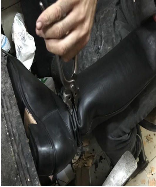
Resim 4.155. Danalya ile körüğün sıkıştırılması
