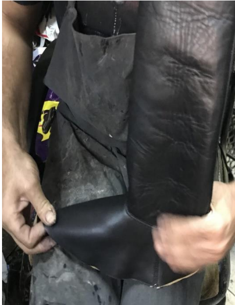
Resim 4.74. Saya yüzeyinin kalıba yerleştirilmesi
