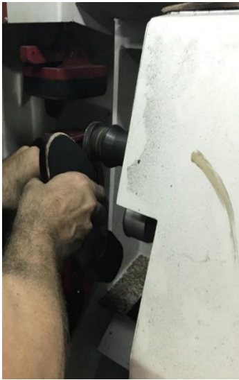
Resim 4.135. Topuk ve tabanın frezelemesi
