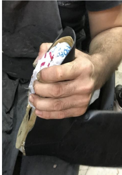
Resim 4.75. Saya yüzeyinin kalıba sıkıştırılması
