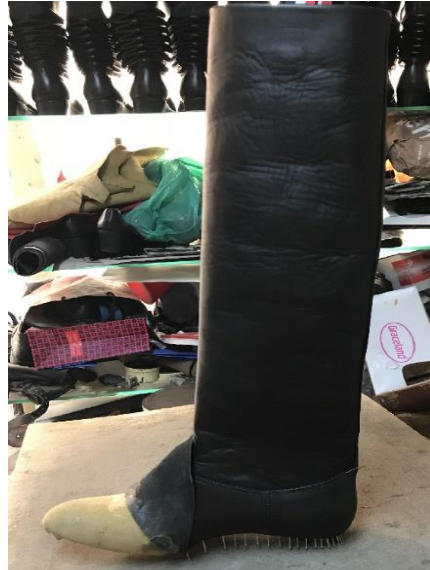
Resim 4.79. Yüze kadar çivileme işlemi
