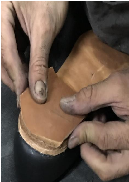
Resim 4.125. İkinci katın yapıştırılması
