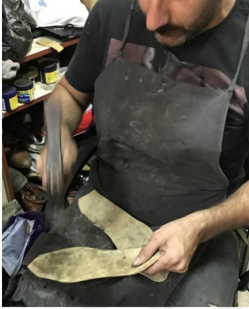
Resim 4.65. Taban astarının dövülmesi
