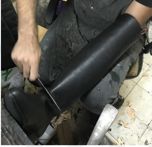
Resim 4.146. Körük kırma işlemi ilk aşaması
