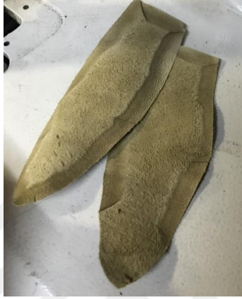
Resim 4.104. Üst taban kamarası tıraşlanması
