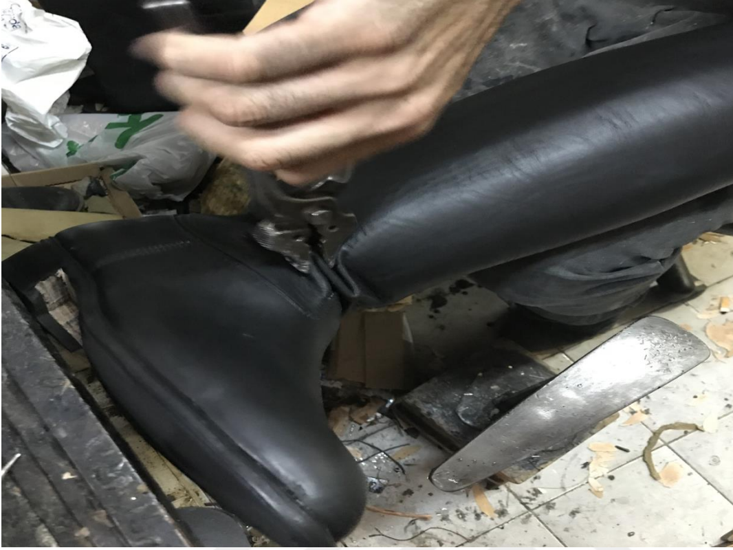
Resim 4.150. İkinci körüğün danalya ile sıkılması
