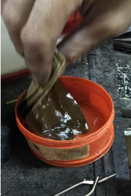
Resim 4.105. Meşin üst taban kamarasının gaz yağına batırılması
