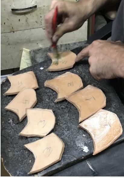
Resim 4.116. Taban ve topuk köselesine yapıştırıcı sürülmesi
