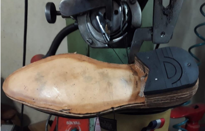
Resim 4.133. Kenar dikişin yapılması
