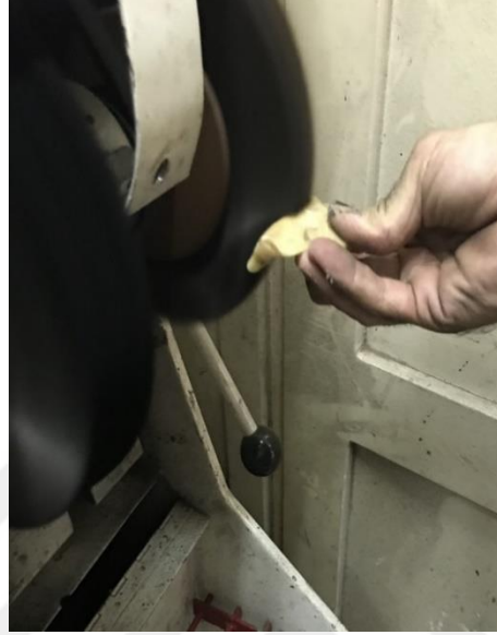
Resim 4.138. Dolgu mumunun sürülmesi
