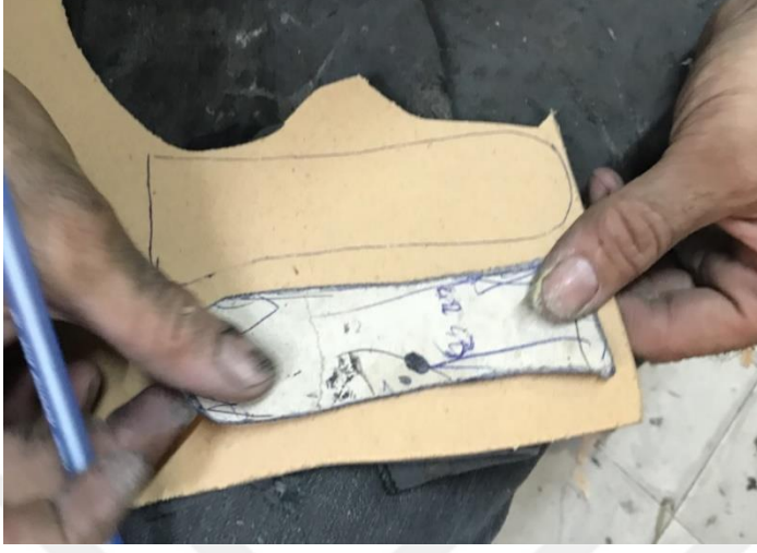
Resim 4.100. Topuk kamarasının kesilmesi
