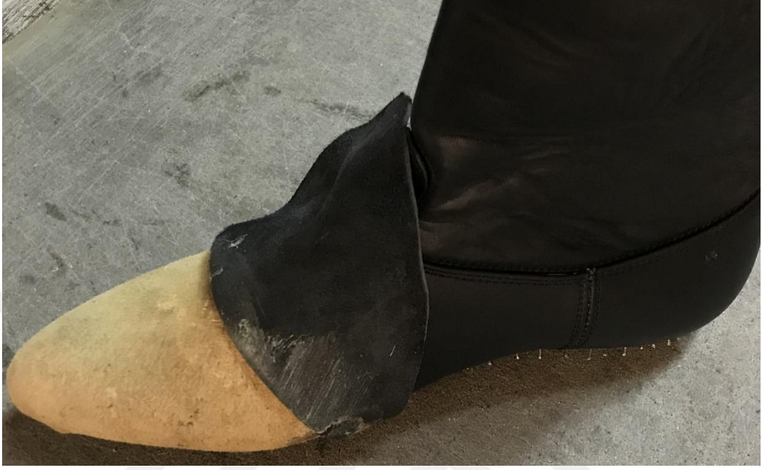
Resim 4.80. Silikon yapıştırıcının sürüleceği yüzey
