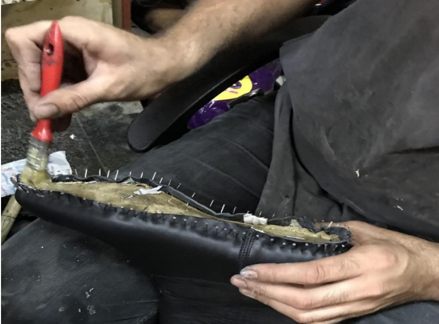
Resim 4.87. Saya taban derisinin, taban astarına yapıştırılması
