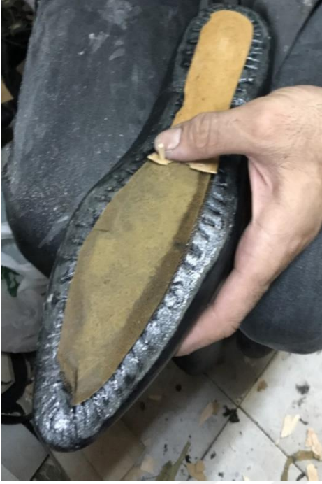
Resim 4.110. Ahşap çivi çakılması
