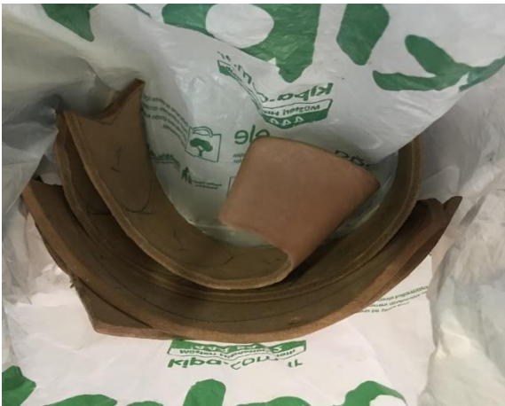
Resim 4.93. Kesilmiş taban ve topuk köselesi tavlama işlemi
