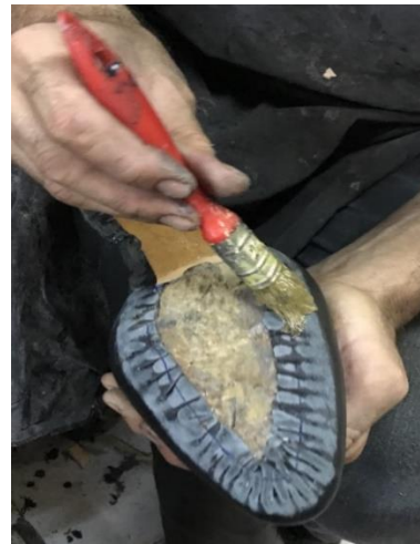
Resim 4.109. Üst taban kamarasının yapıştırılması
