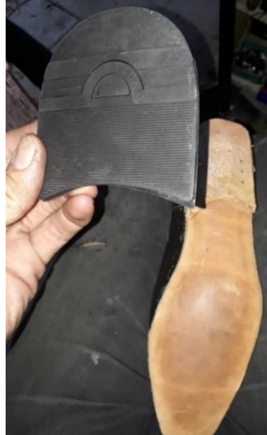
Resim 4.130. Topuk lastiğinin yapıştırılması
