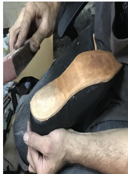
Resim 4.122. Topuk yüzeyinin temizliği
