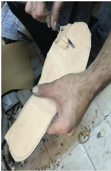
Resim 4.114. Taban kösesinin temizlenmesi
