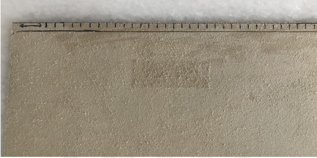
Resim 4.165. Birleştirme deliklerinin işaretlenmesi
