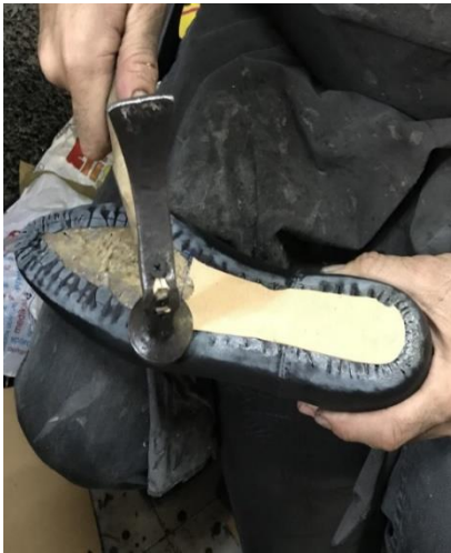
Resim 4.108. Topuk kamarasının yapıştırılması
