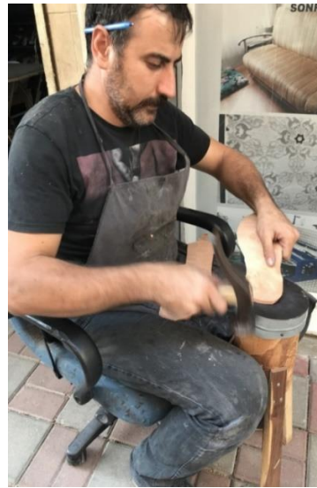
Resim 4.115. Taban ve topuk kösesinin dövülmesi
