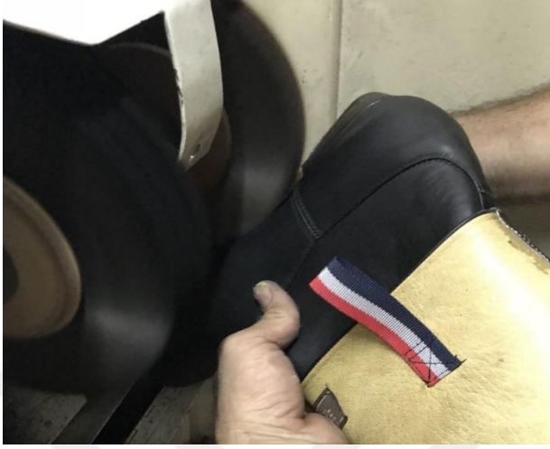
Resim 4.141. Topuk kösesinin kenar mumu ile fırçalanması
