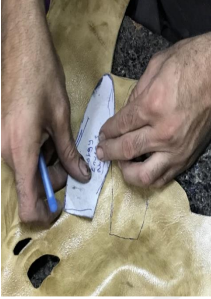
Resim 4.103. Üst taban kamarasının kesilmesi
