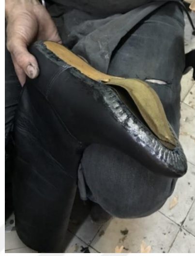
Resim 4.113. Kamara boşluğunun bırakılması
