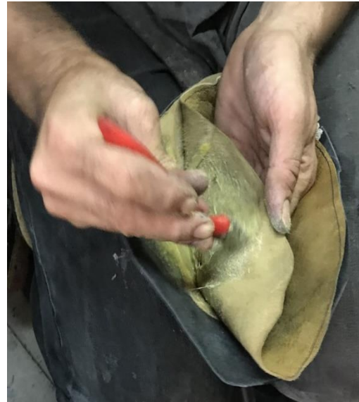
Resim 4.71. Sayanın astara yapıştırılması
