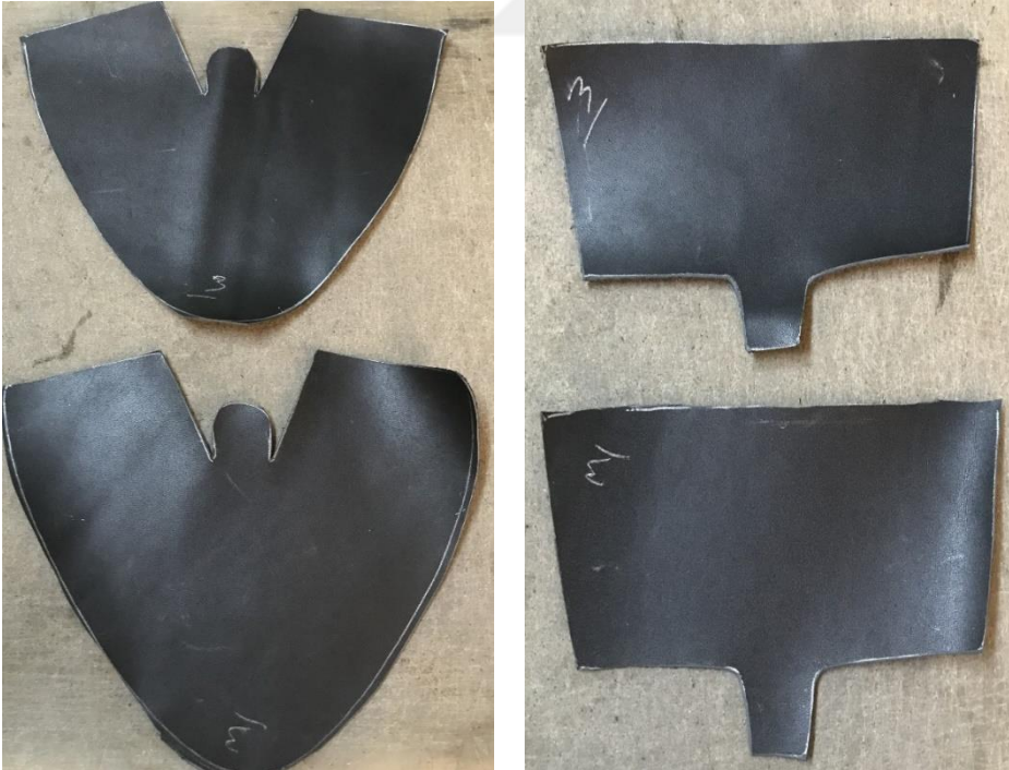
Resim 4.59. Yüz ve fort kalıpların kesilmesi
