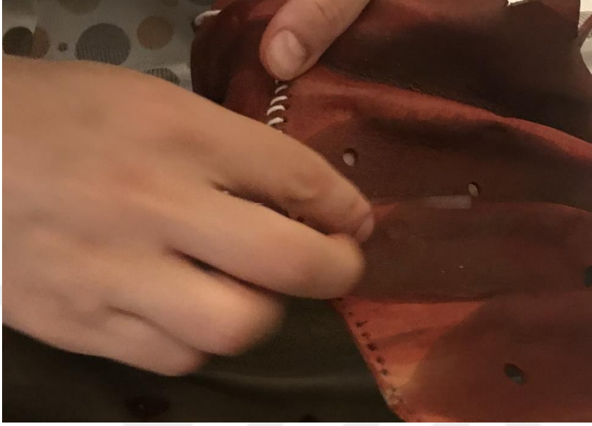
Resim 4.176. Birleştirme dikişinin yapılması
