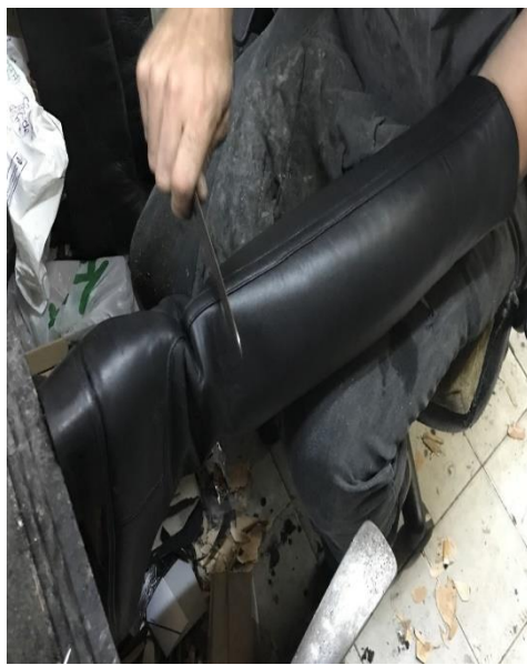
Resim 4.152. İkinci arka körüğün kırılması
