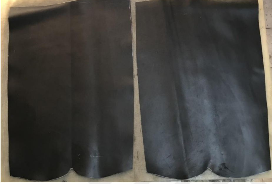
Resim 4.58. Baldır kalıpların kesilmesi
