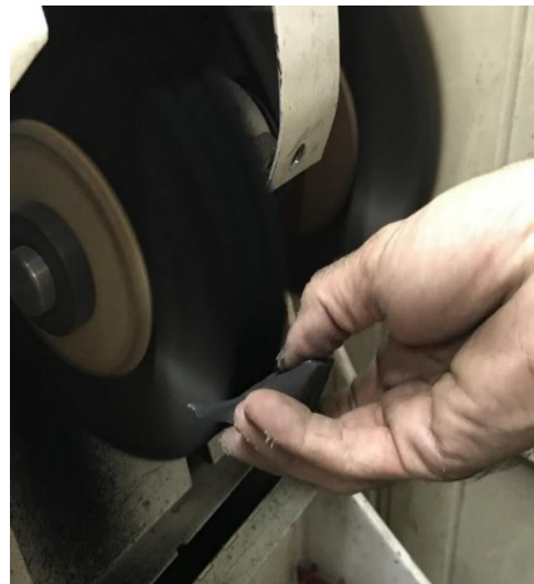
Resim 4.140. Kenar mumunun sürülmesi
