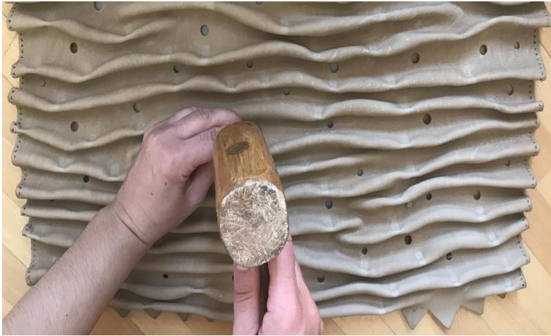
Resim 4.173. Krk arası deliklerin aılması
