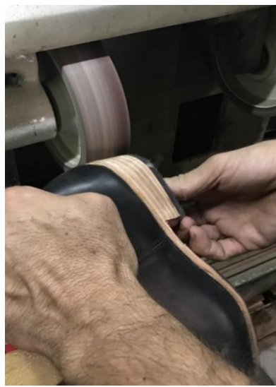
Resim 4.136. İkinci frezeleme işlemi
