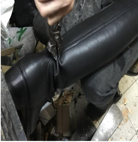
Resim 4.153. Arka körüğün sıkıştırılması
