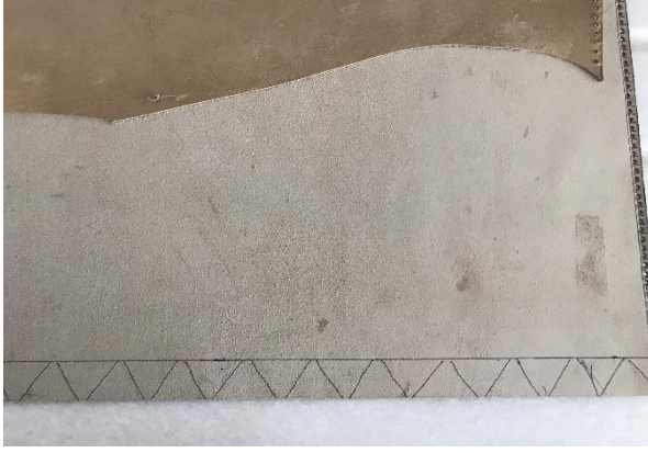
Resim 4.167. Birleştirme kanallarının çizilmesi
