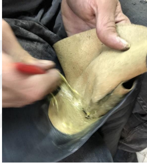
Resim 4.69. Fort astarına yapıştırıcı sürülmesi
