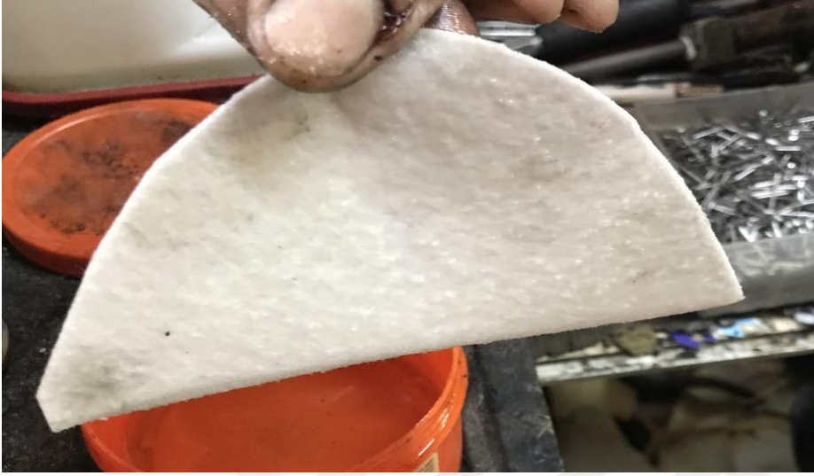
Resim 4.82. Bombenin bombe suyuna batırılması
