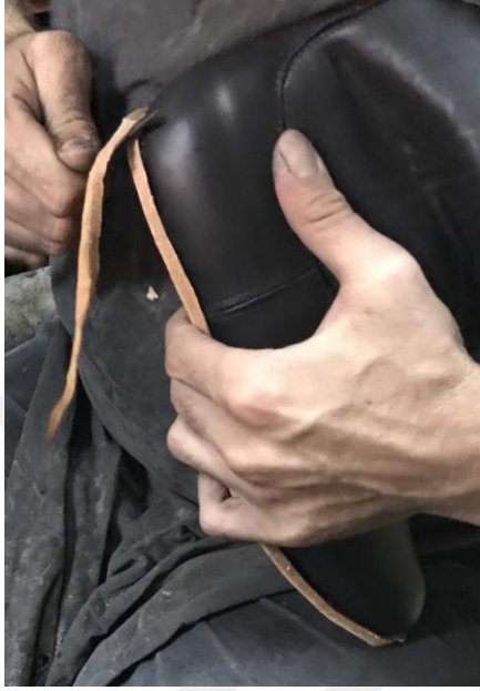
Resim 4.119. Taban fazlalığının alınması
