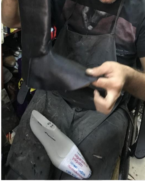
Resim 4.72. Kalıba naylon sarılması
