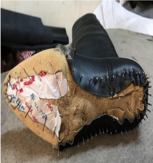
Resim 4.78. Yüze kadar çivileme işlemi
