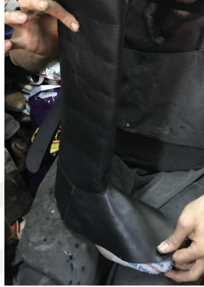
Resim 4.73. Saya yüzeyinin kalıba ortalanması
