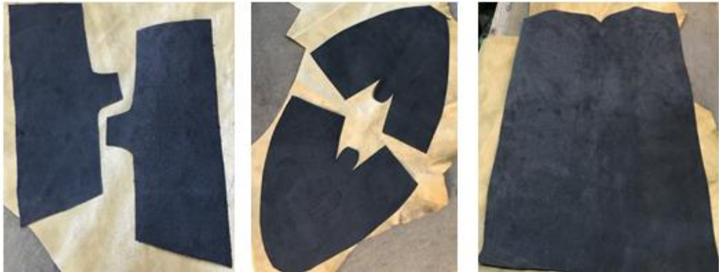
Resim 4.61. Fort, yüz ve baldır ıstampalarının iç astara yerleştirilmesi ve kesilmesi
