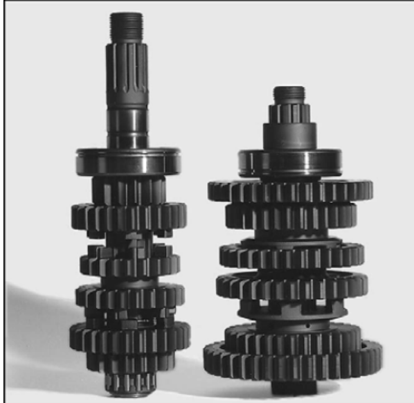
Şekil 6.1 WC/C kaplanmış dişliler (Corbella, 2005)
