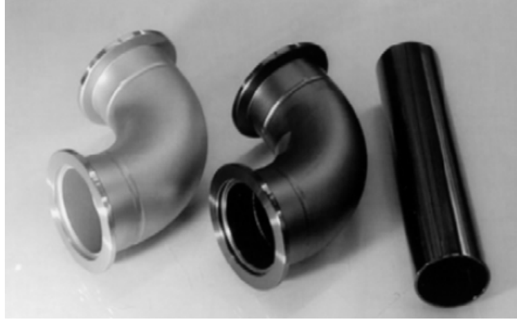
Şekil 6.3 Kaplanmamış (en soldaki) ve DLC kaplanmış borular (Corbella, 2005)
