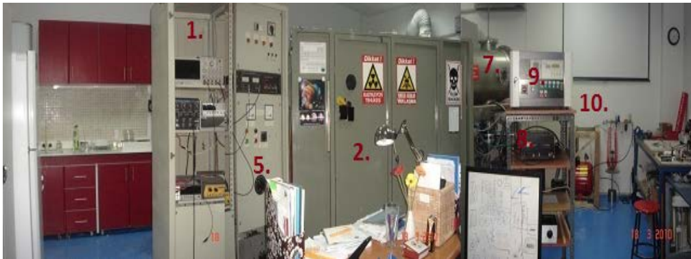
Şekil 7.2 Ege Üniversitesi Yüzey Modifikasyon Laboratuvarı'nın genel görüntüsü (1. Elektrik - elektronik donanım kontrol paneli, 2. Yüksek gerilim odası, 3. Mevva iyon üretici, 4. Ark ve tetikleyici güç kaynağı, 5.a. Ark akımı kontrolü 5.b. İyon hızlandırıcı kontrolü, 6. İzolasyon trafosu, 7. Yüksek gerilim güç kaynağı (110 kVdc), 8. Yüksek gerilim, 9. Vakum sistemi) (Sokullu Urkaç, 2010).
