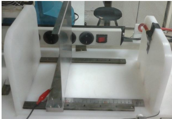
Şekil 3. 6 Rastgele dizili nanofiberleri toplama yüzeyi.
