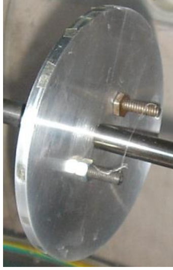
Şekil 3. 7 Düzgün dizili nanofiberleri toplama yüzeyi.
